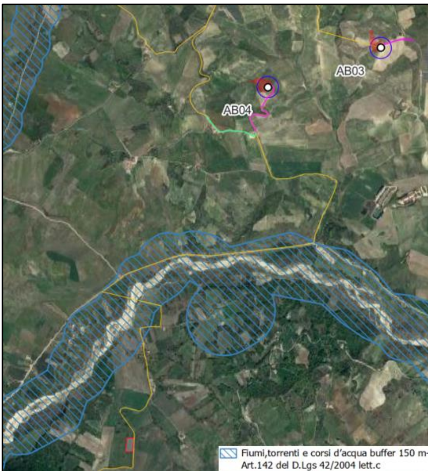
Figura 7.1.1.10: Interferenza tra “Fiumi torrenti corsi d’acqua buffer 150” (D.Lgs. 42/2004 Art. 142 lettera c) e la linea MT – Attraversamento in TOC
