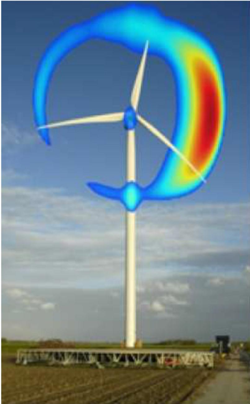
Rumore rilevato con SISTEMA BEAMFORMING
