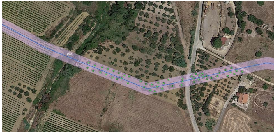
Fig. 2.1/A: Stima conta ulivi (in rosa la fascia dei lavori, in blu la condotta e in verde gli alberi di ulivo interferiti)
