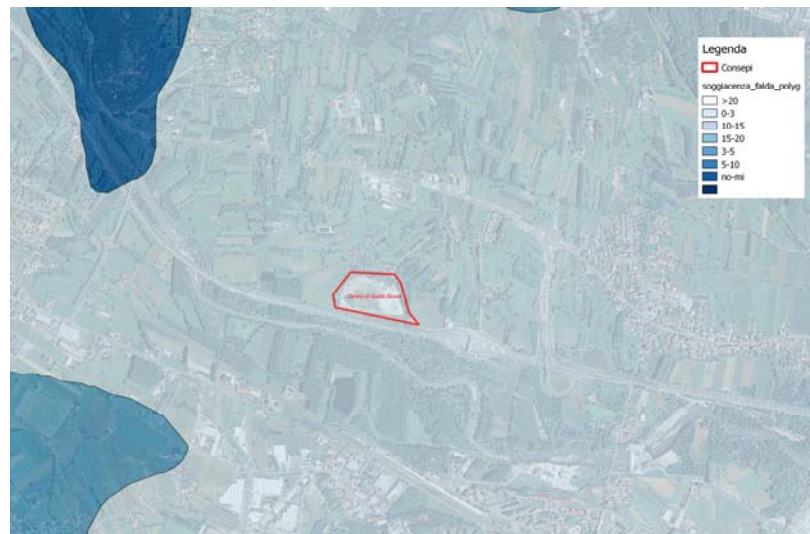
Fig. 34 – Soggiacenza falda superficiale
