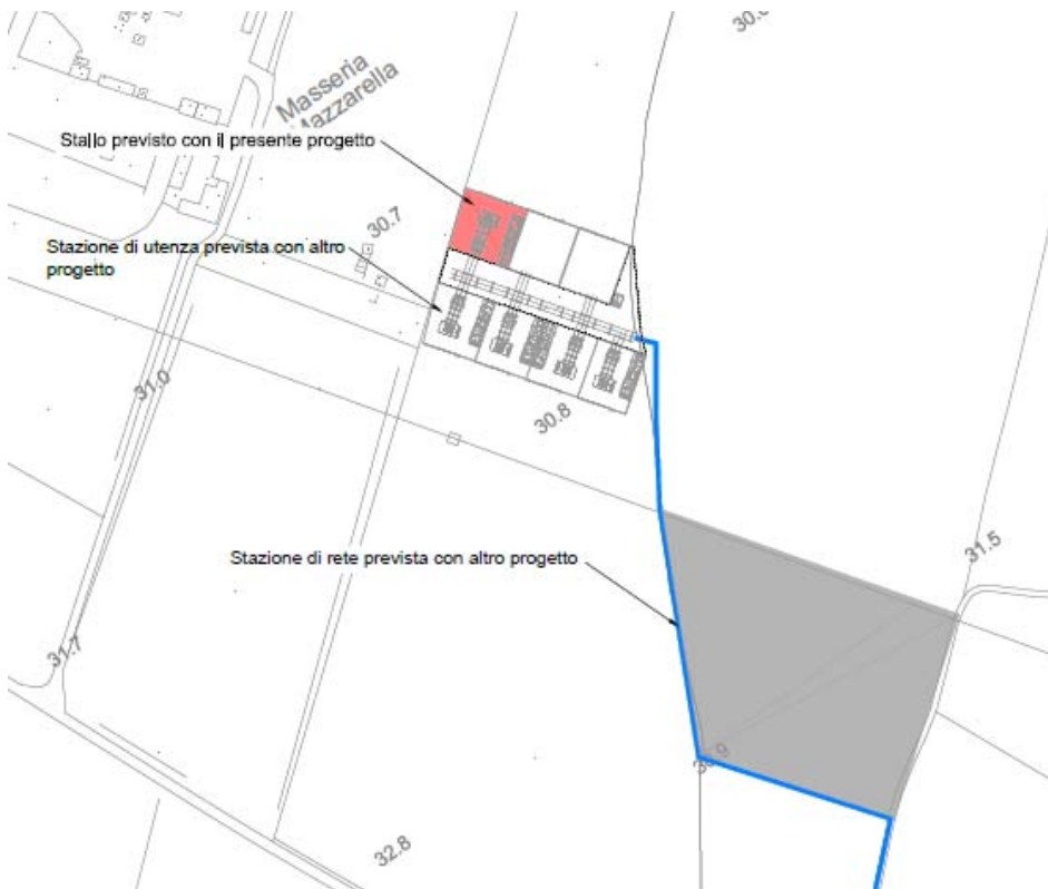
Connessione Stazione di Utenza – Stazione di Rete
