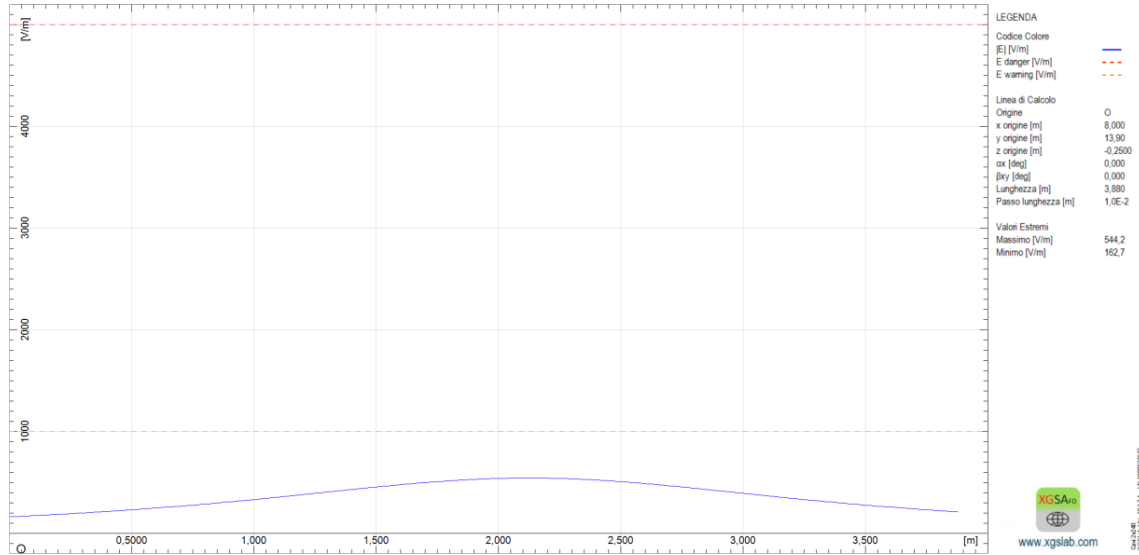
Figura 2: Profilo Campo Elettrico ad altezza 0,25 m
