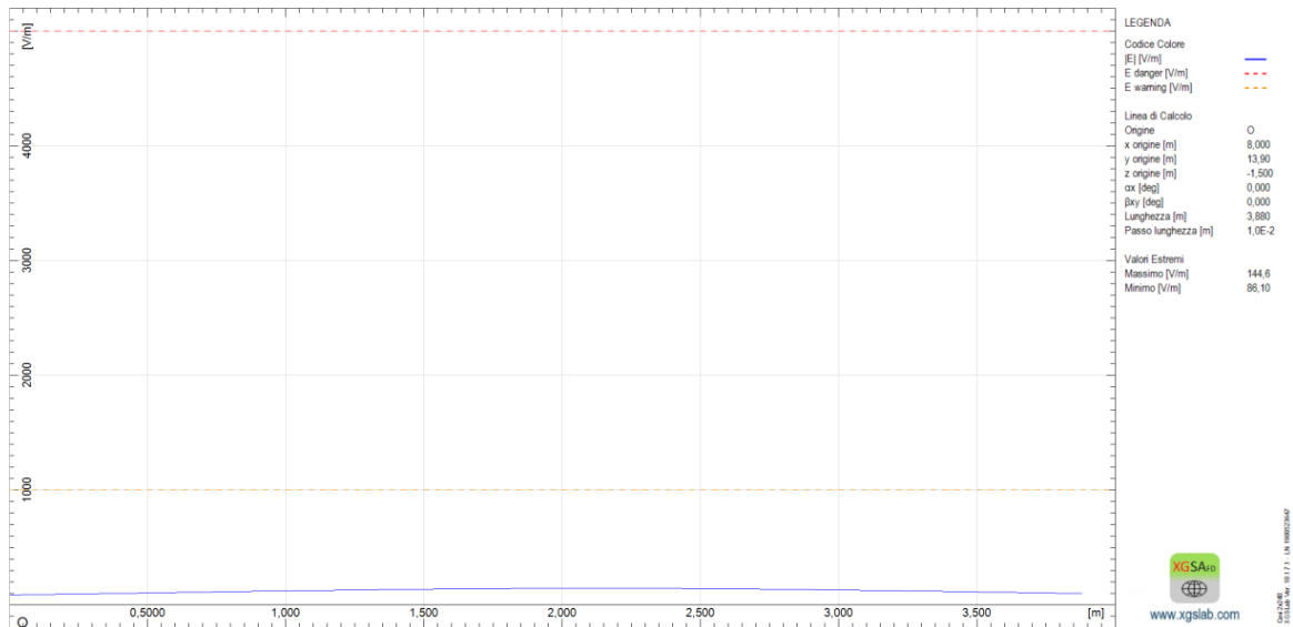
Figura 3: Profilo Campo Elettrico ad altezza 1,5 m
