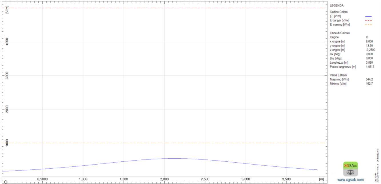
Figura 6: Profilo Campo Elettrico ad altezza 0,25 m
