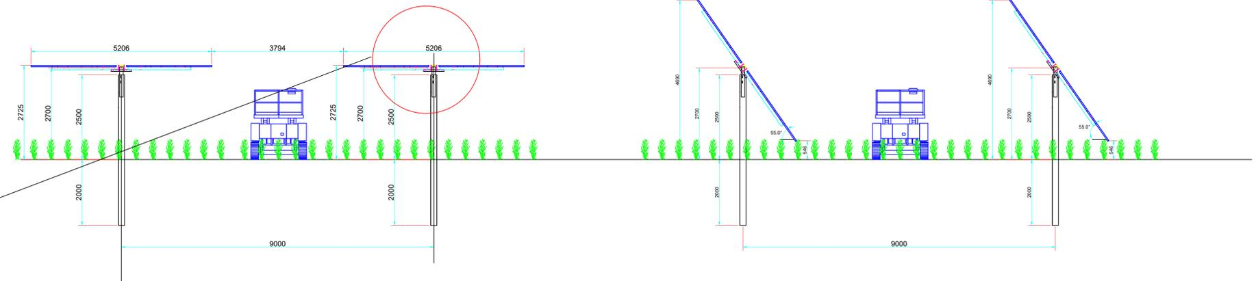
**Tracker - Sezione di dettaglio**
