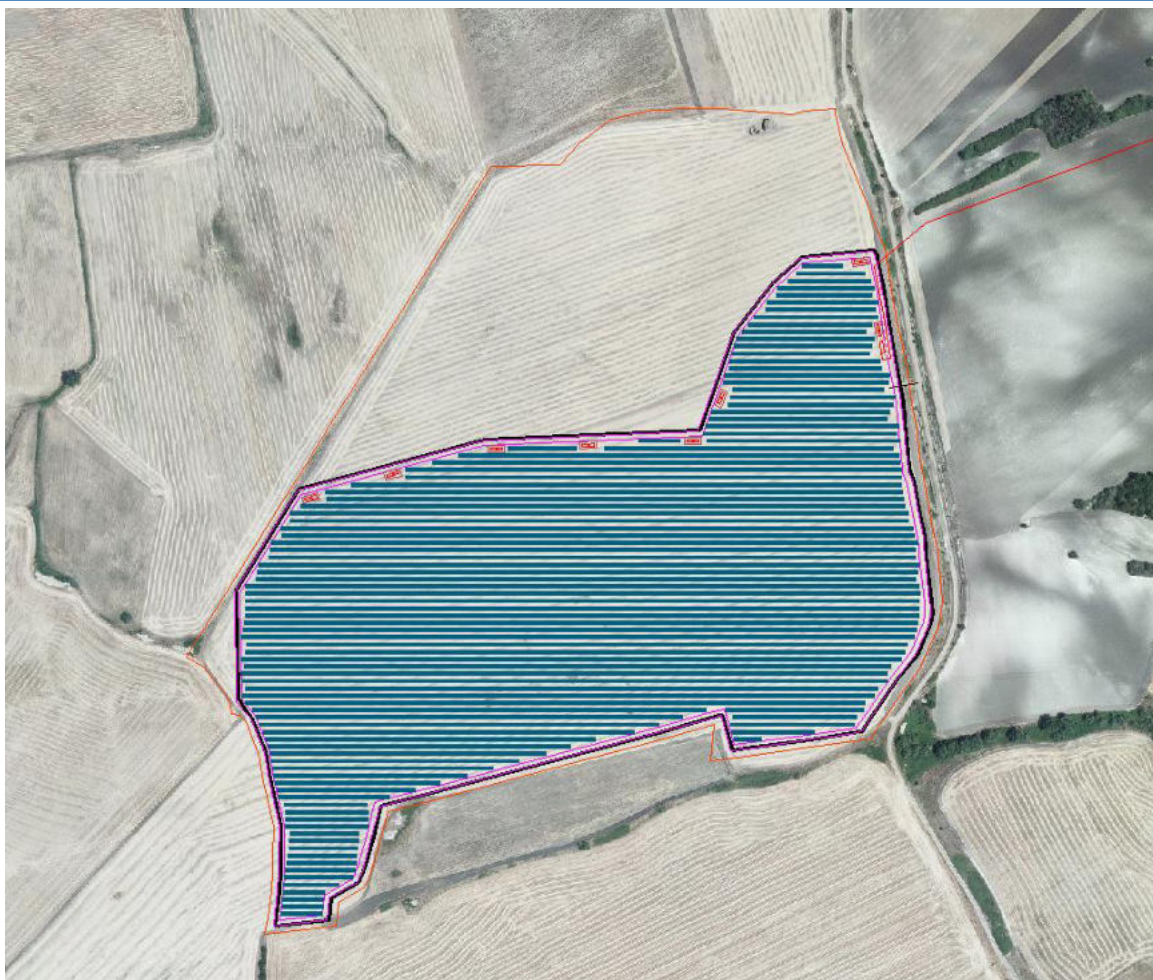
Figura 7.2. – Layout del sistema fotovoltaico con supporti fissi.
