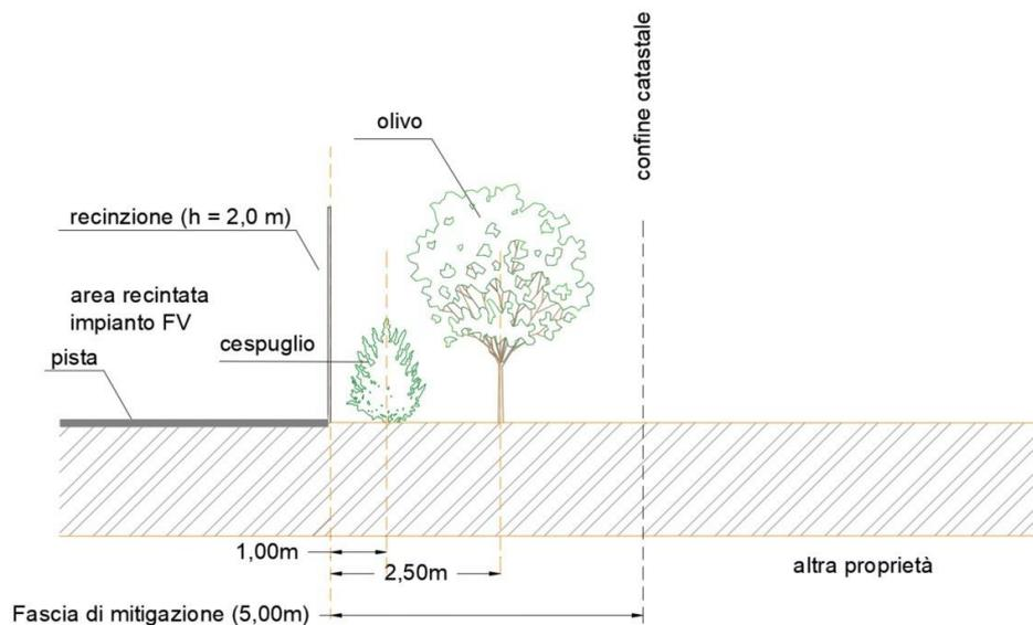
Figura 2.13. – Stralcio di sezione dell'area perimetrale dell'impianto.
