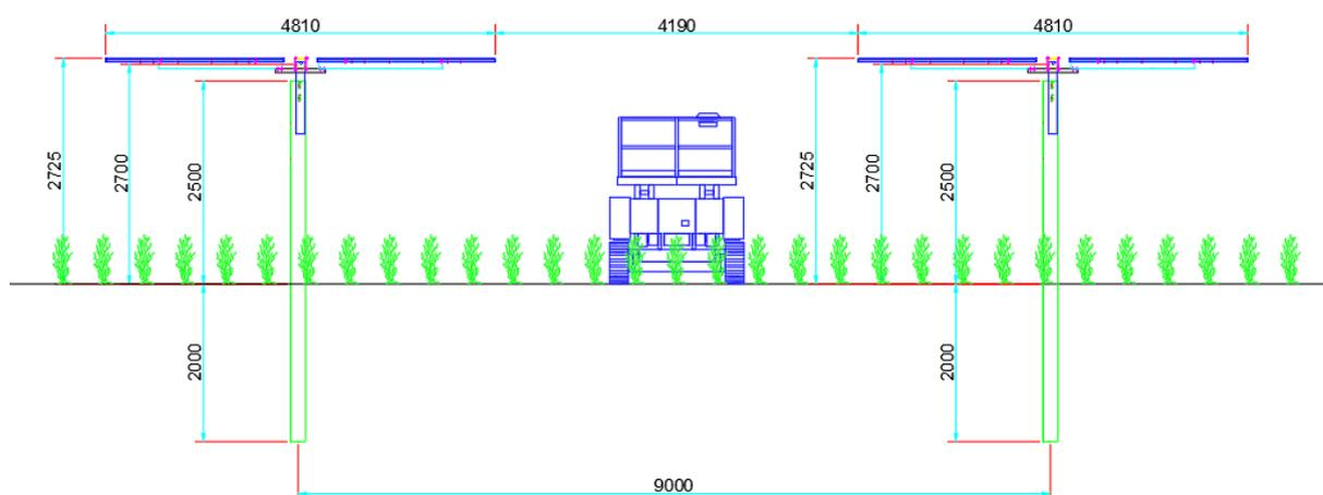
Figura 2.2. – Area di insidenza massima del modulo fotovoltaico raggiunta in posizione orizzontale.
