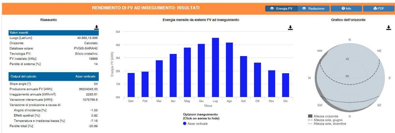
Figura 4.7. – Rendimento dell’impianto e delle caratteristiche tecnico-produttive con tracker.
