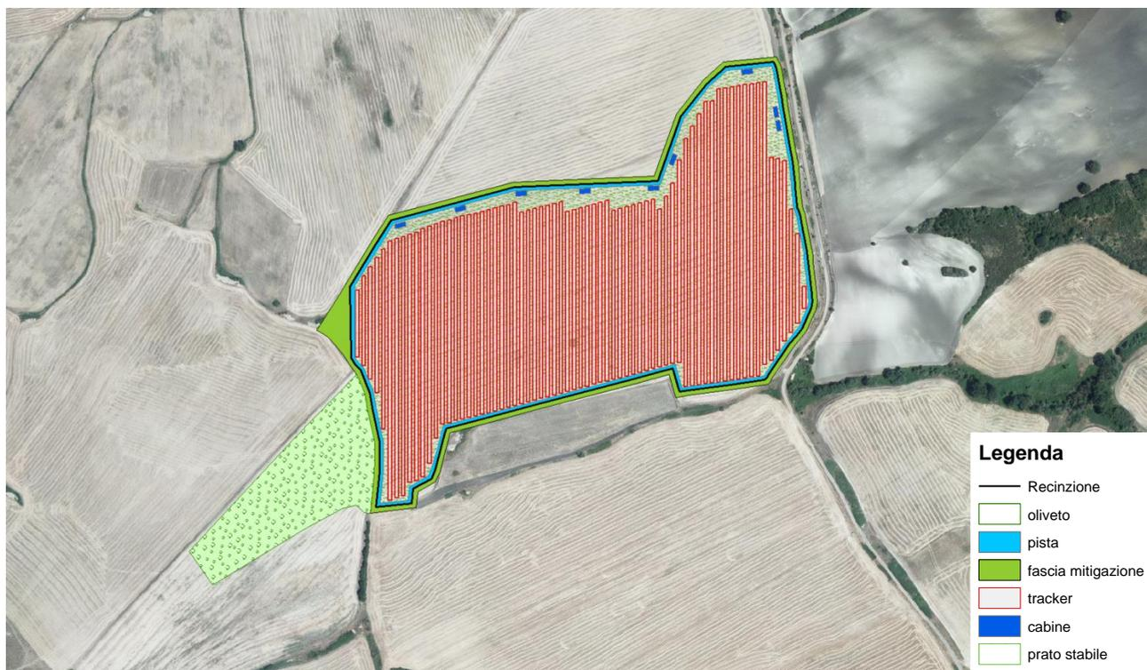
Figura 1.2a – Area di progetto impianto agrivoltaico su ortofoto - dettaglio.
