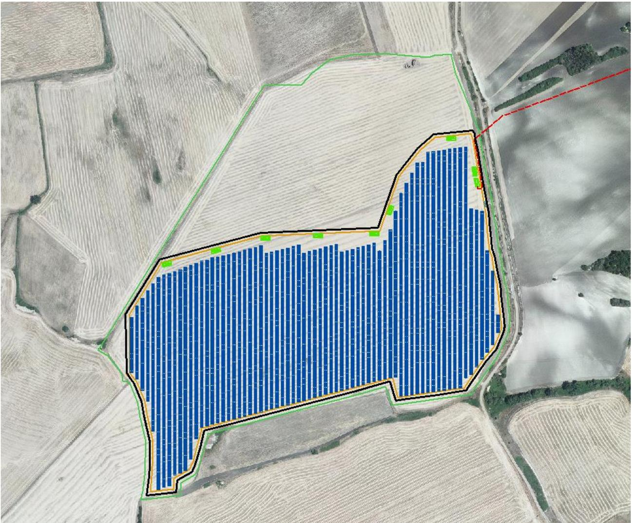
Figura 4.1. – Layout del sistema agrivoltaico con tracker.
