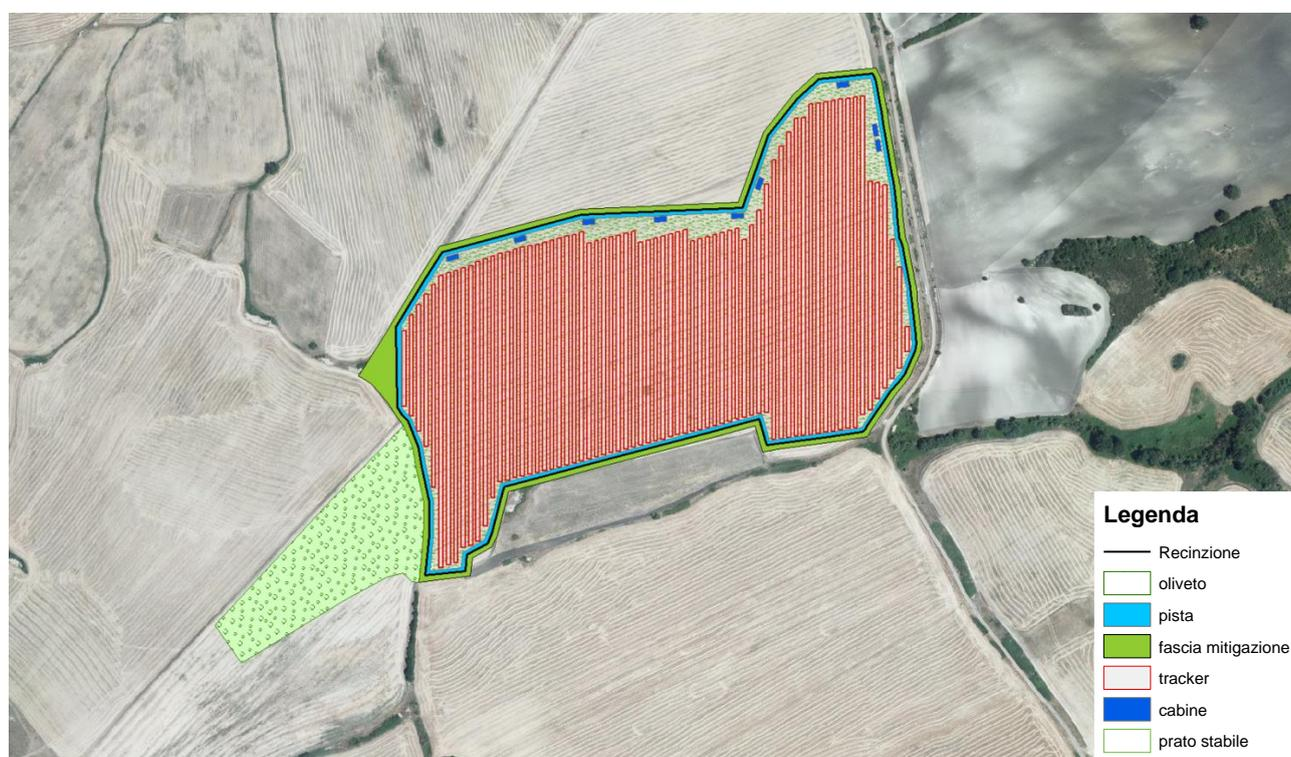
Figura 2.1 – Area di progetto con indicazione degli interventi agronomici e posizionamento dei moduli fotovoltaici.
