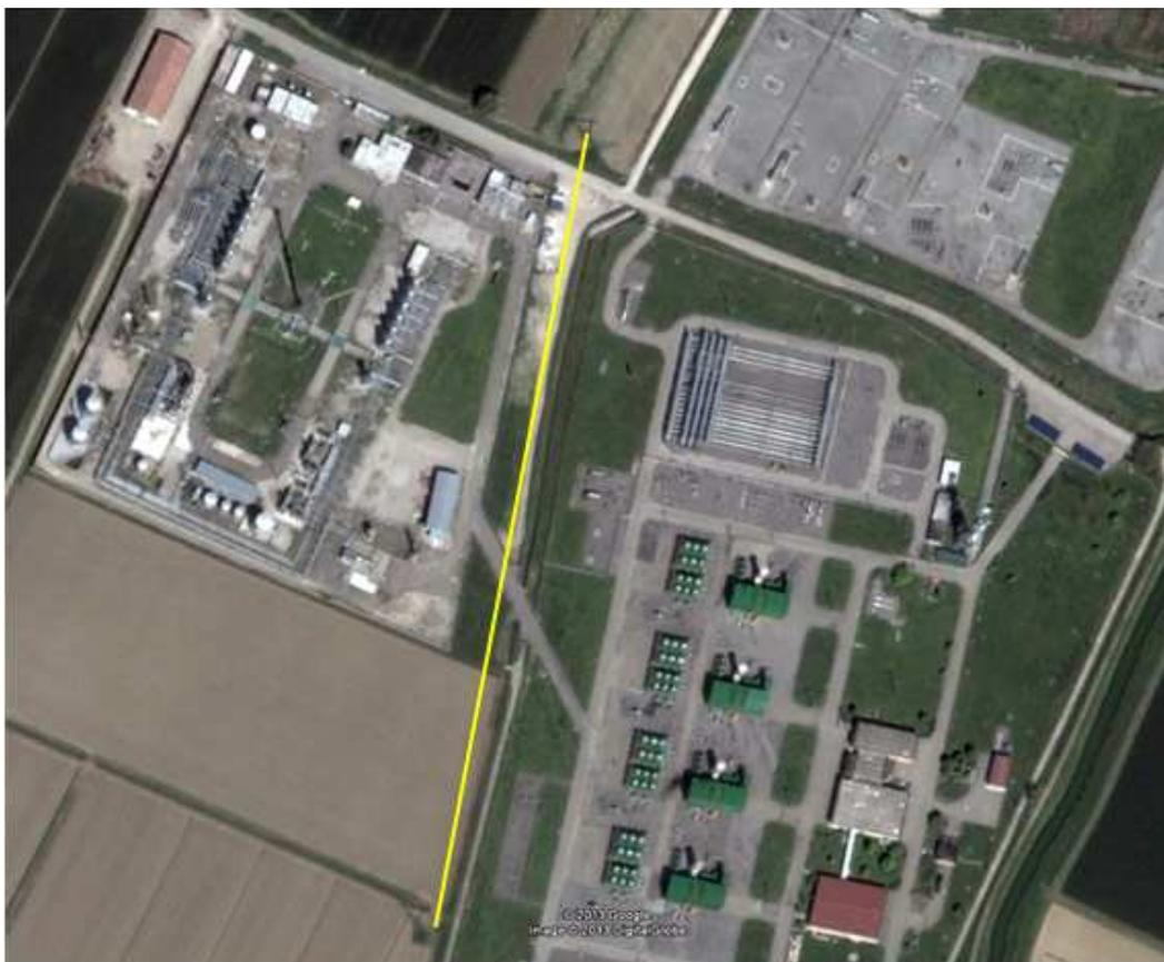
**Figura 2.7.a – Impianti di trattamento (A) e compressione gas (B) della Centrale di stoccaggio di Minerbio con evidenziato in giallo il tracciato della linea elettrica aerea ad alta tensione (132 kV)**
