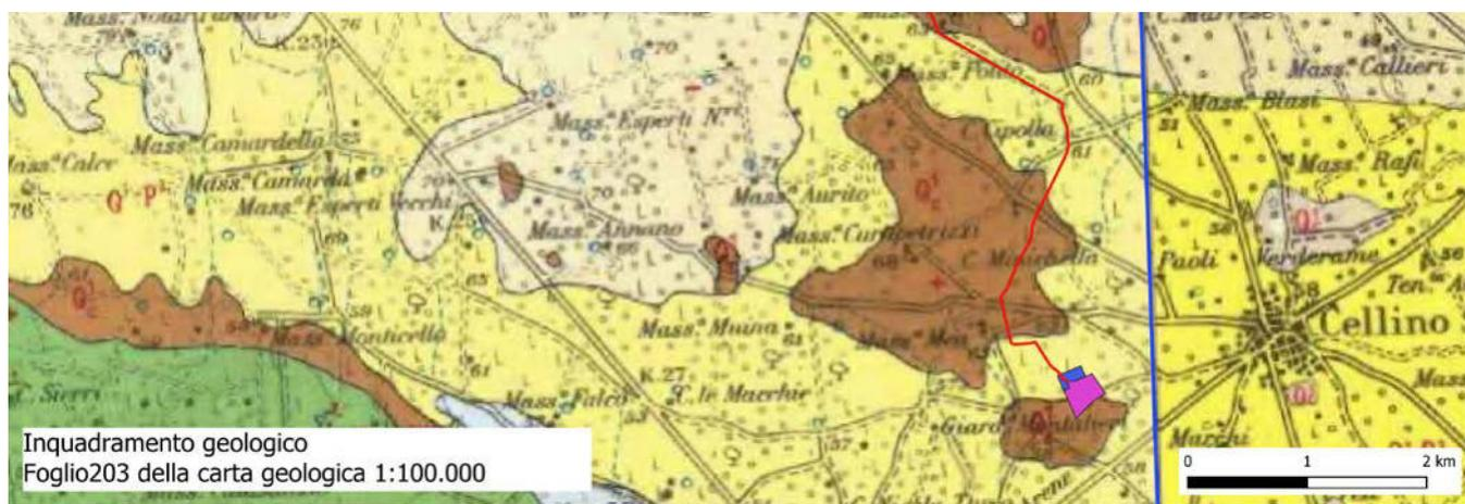
Inquadramento geologico di dettaglio Area Sottostazione Elettrica e cavidotto (Foglio 203 BRINDISI) Carta Geologica 1:100.000
