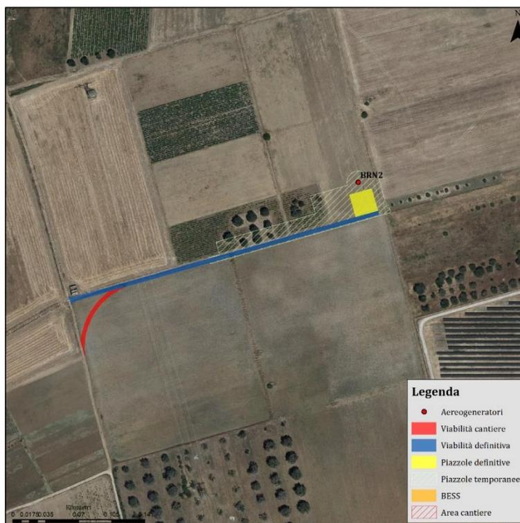
Figura 17: Dettaglio area di impianto ricadenti in seminativo ma con piazzola temporanea in conflitto con ulivi affetti da *Xylella fastidiosa*: aerogeneratore BRN2
