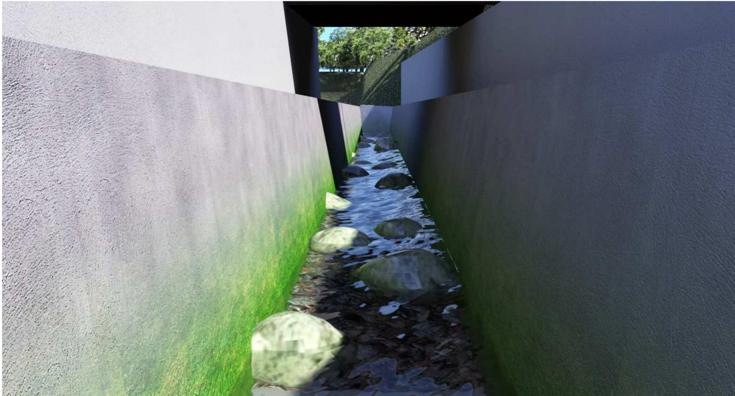
Figura 55 – Render: vista del canale di continuità biologica – particolare della disposizione dei massi
