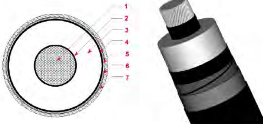
**Figura 2-11: Schema tipico del cavo AT a 150 kV**
