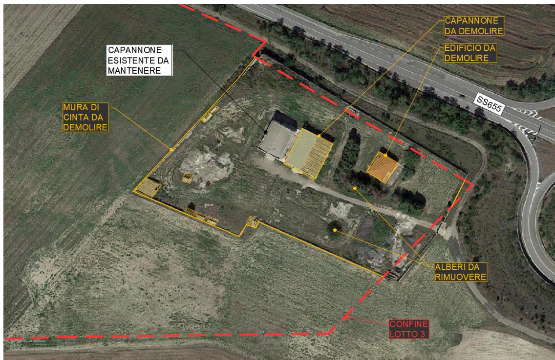
Figura 9: Planimetria demolizioni lotto 3
