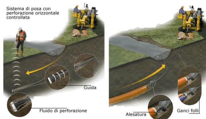
Figura 15: Posa in opera tubazione per alloggiare cavi
