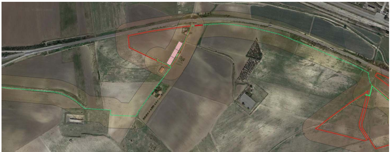
Figura 81: Diffusione polveri e particelle sottili, buffer 56 m dalle aree di cantiere impianto FV -
