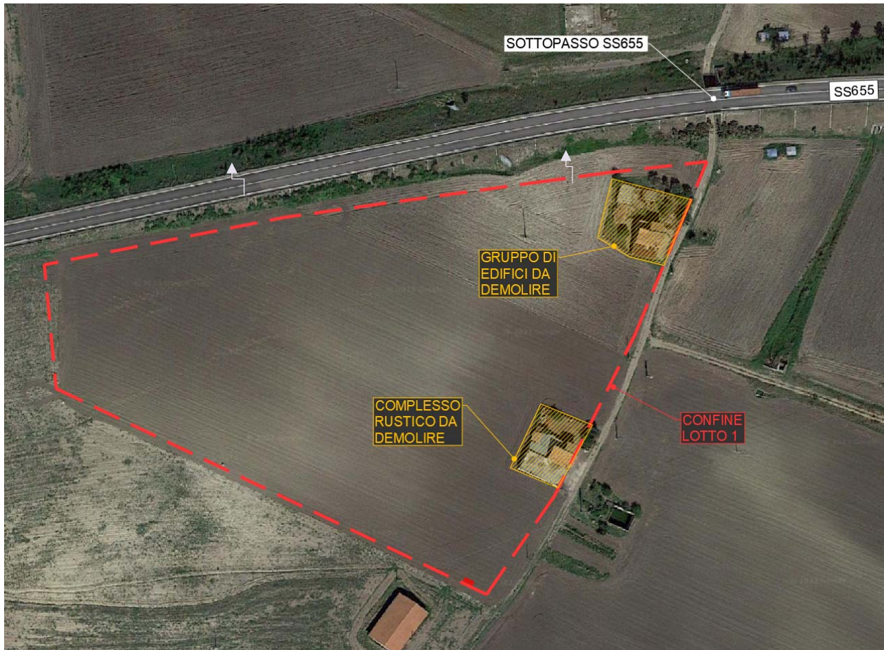
Figura 62: Planimetria demolizioni - Lotto1
