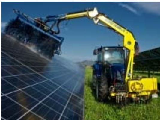
La **pulizia dei moduli** avviene mediante il passaggio di macchine automatiche dotate di spazzole. Tali macchine sono tipicamente dotate di sistemi per la demineralizzazione dell'acqua, in modo da non lasciare aloni o residui di calcare sui moduli. Un esempio di macchina per la pulizia dei moduli FV è mostrato nell'immagine.
