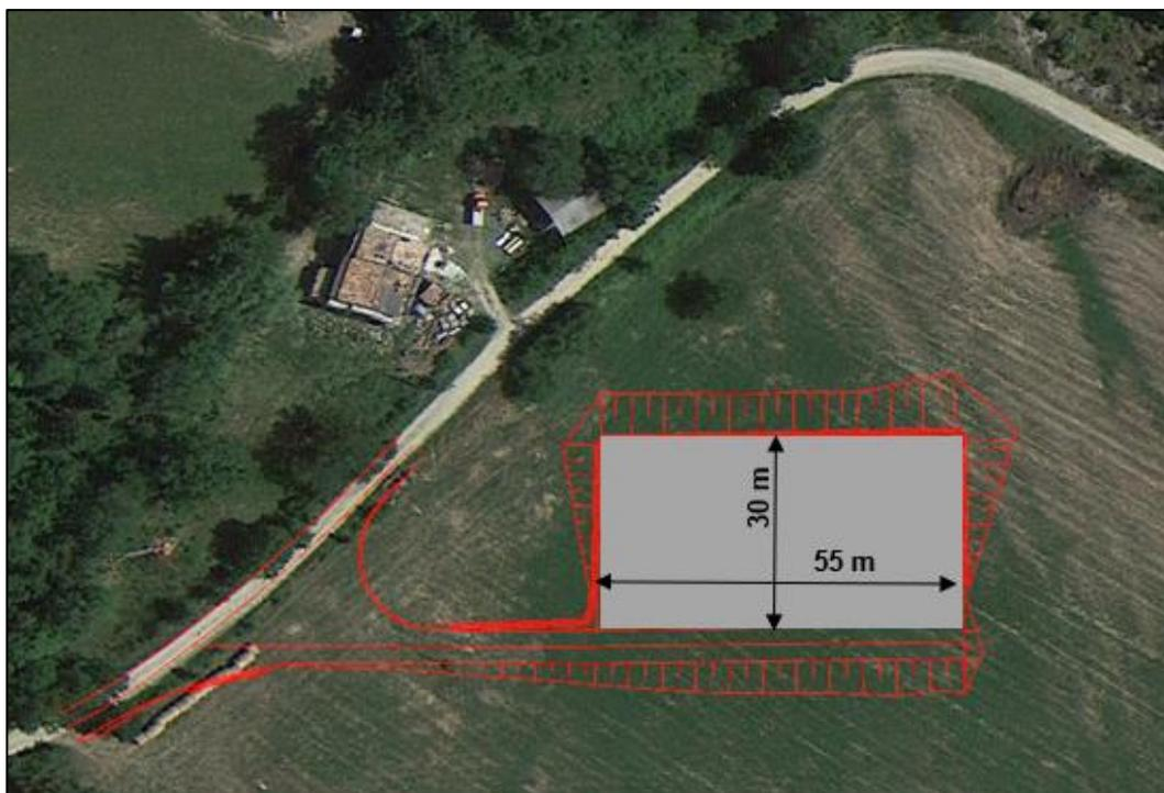
Figura 3 – Dettaglio area di cantiere
