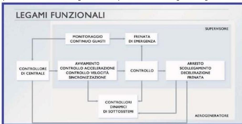
Figura 1.1: Schema di controllo e supervisione dell'aerogeneratore
