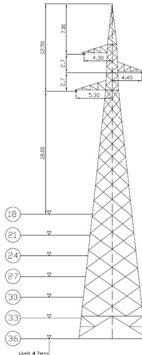
Sostegni tronco piramidali a traliccio tipo "C/E st" (1 – 220kV)
