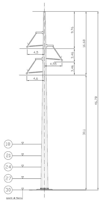
Sostegni tubolari monostelo schema generale palo tipo "NST" (2 – 220 kV)
