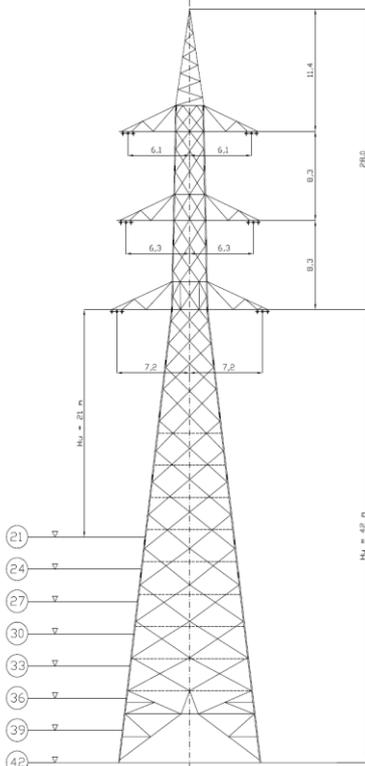
Sostegni tronco piramidali a traliccio 380kV: tipo "EA" dt (56, PC)
