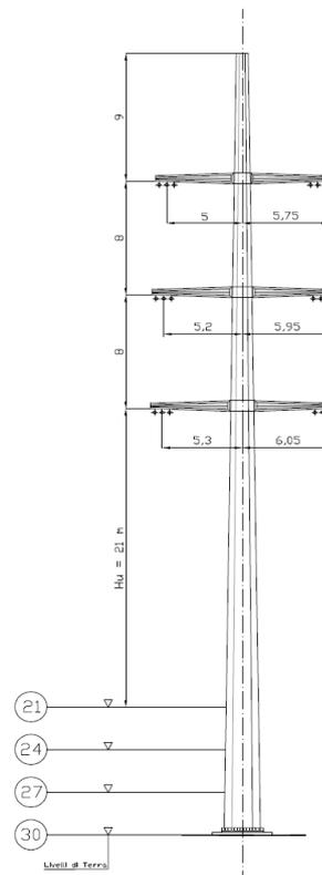
Sostegni tubolari monostelo schema generale palo tipo "AN" dt (111 – 380 kV)
