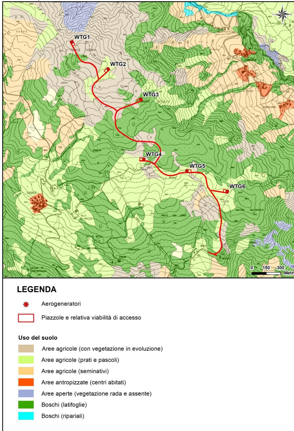
Figura 3.1.2a Area di Progetto: piazzole degli aerogeneratori (identificati dalla sigla WTG) e relativa viabilità di accesso in fase di esercizio, in relazione all'uso del suolo (fonte: fonte: rielaborato da "Carta Natura" della Toscana e delle Marche)
