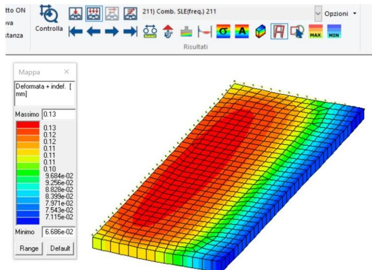
Figura 65 cedimento massimo frequente
