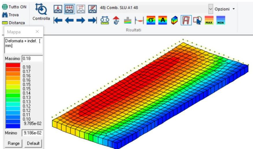
Figura 53 Deformazione MAX verticale Comb 48 SLU 0,18mm
