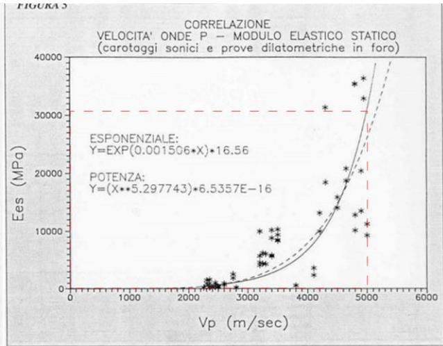
Figura 8 RMR- Vp - Modulo elastico statico
