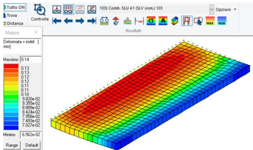
Figura 54 Deformazione MAX orizzontale Comb 103 SLV 0,14mm
