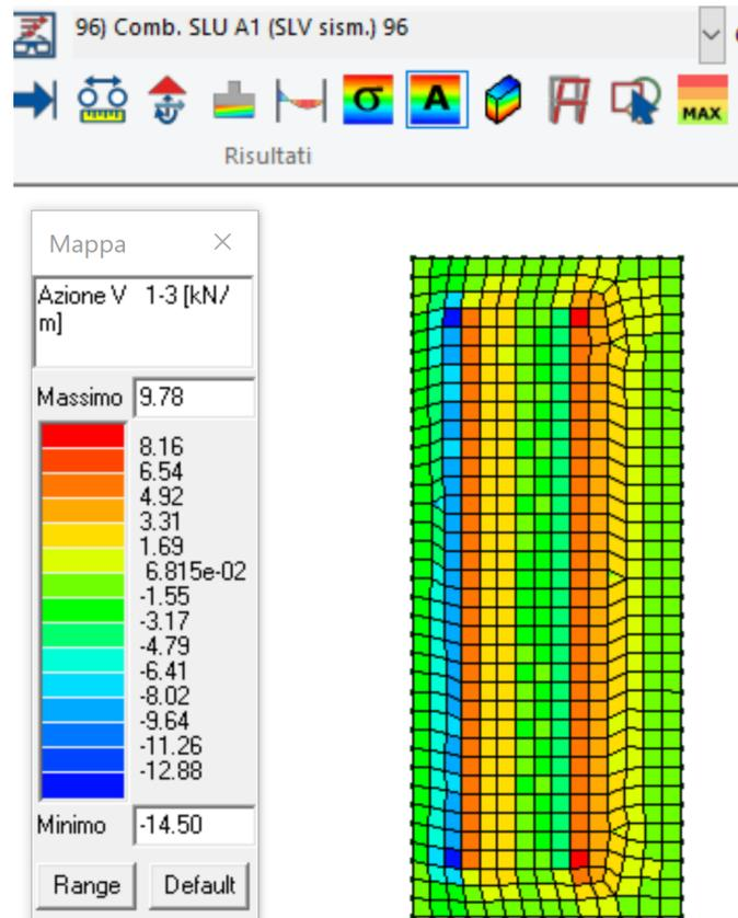
Figura 49 V1-3 min SLV fondazione
