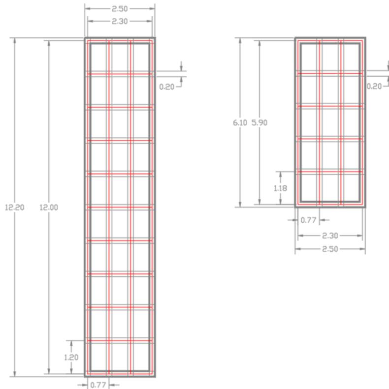
Figura 15 geometria di modellazione dei containers
