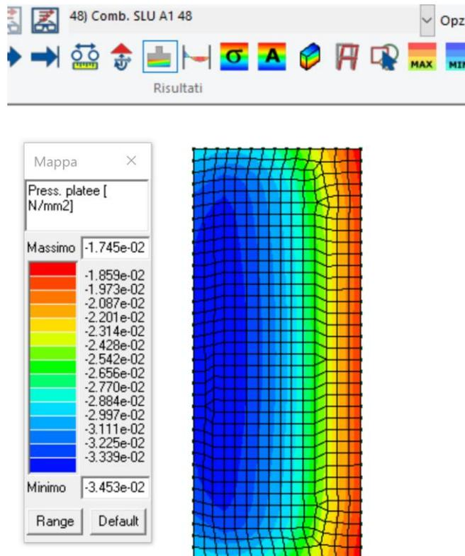
Figura 67 Tensioni MIN di contatto Comb SLU 48
