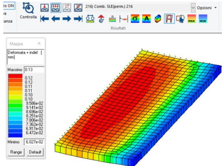
Figura 66 cedimento massimo permanente
