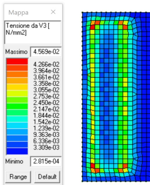
Figura 56 verifica tensionale V3 fondazione
