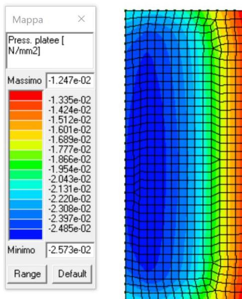
Figura 68 Tensioni di contatto MIN Comb SLV 103
