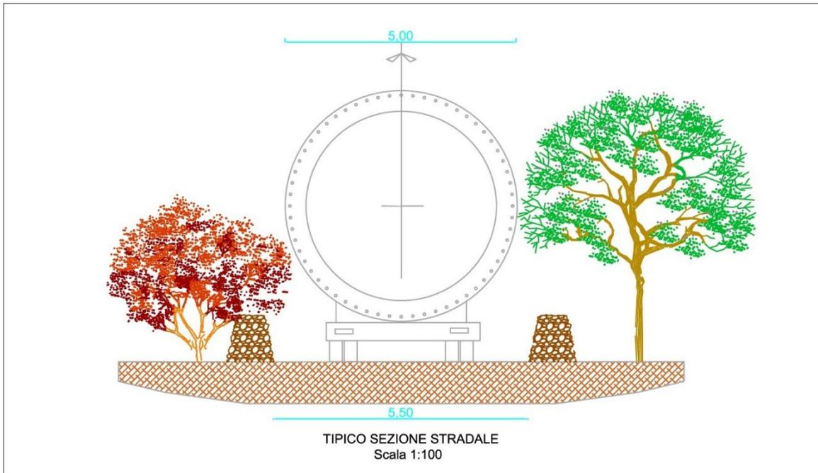
Figura 11 – Tipico inserimento del trasporto eccezionale nell estrade rurali con presenza di muri a secco.
