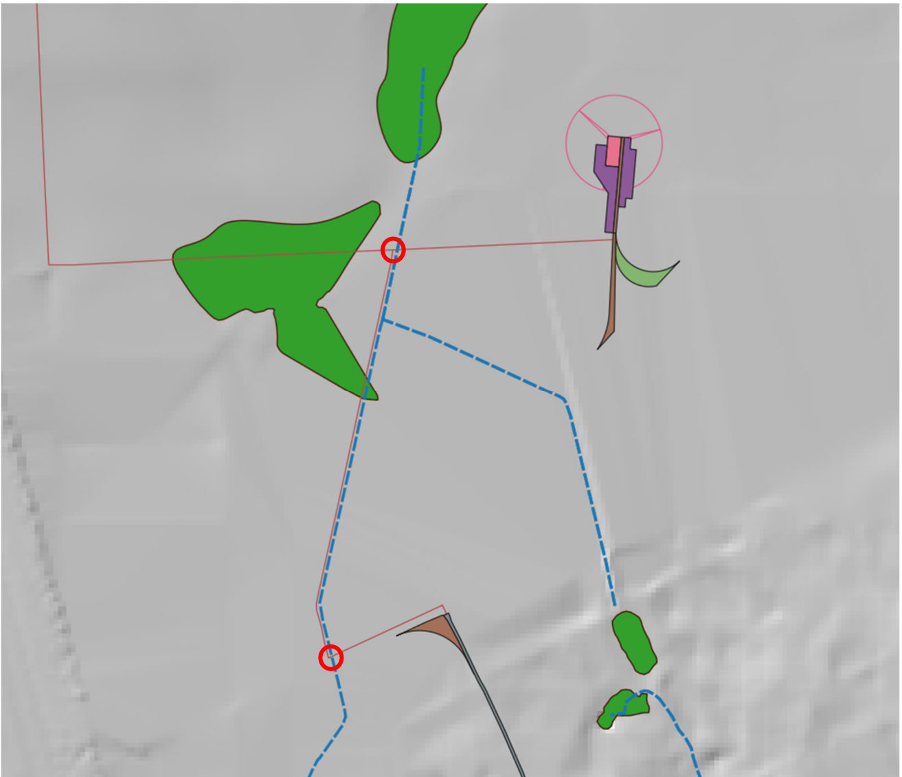
Fig. 4.3.1 – Perimetrazioni su DTM Puglia delle aree allagabili in prossimità della intersezione tra cavidotto e rete idrografica cartografata sulla Carta Idrogeomorfologica
