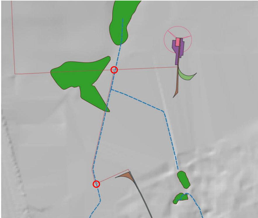
Perimetrazioni su DTM Puglia delle aree allagabili in prossimità della intersezione tra cavidotto e rete idrografica cartografata sulla Carta Idrogeomorfologica
