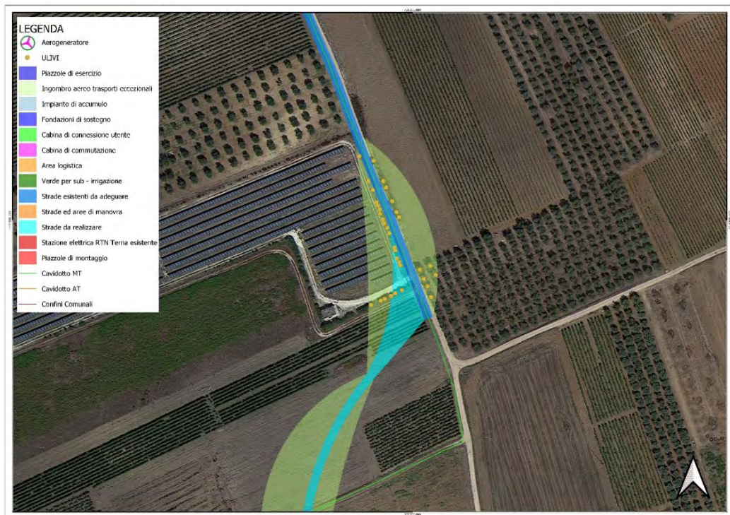
Fig.27 sub10 – Proseguimento curva ingresso area impianto N06
