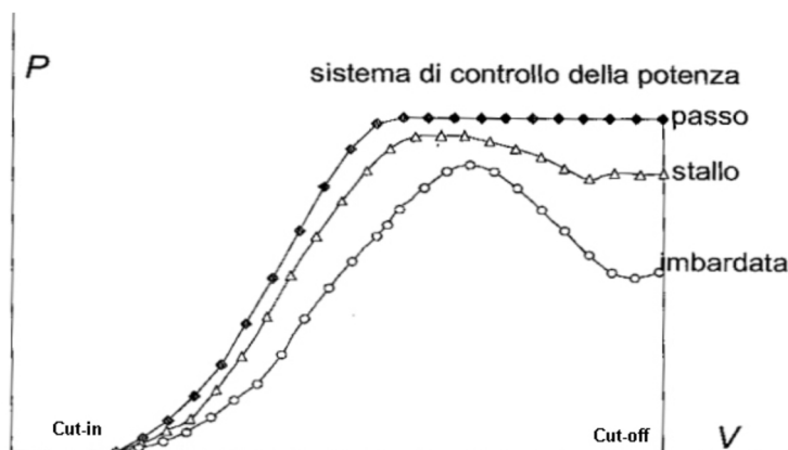
Figura 11. Effetto dei sistemi di controllo sulle curve di potenza
