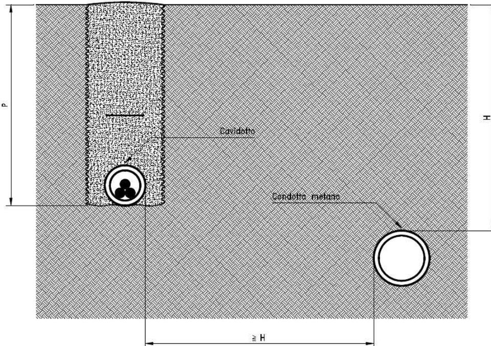
**Figura 9 - Parallelismi con gasdotti - pressione gas >5 bar**
