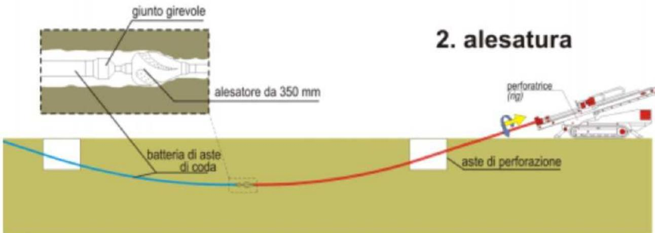
*Figura 2. Schema della fase di trivellazione/i di allargamento del perforo (Back-Reaming)*
