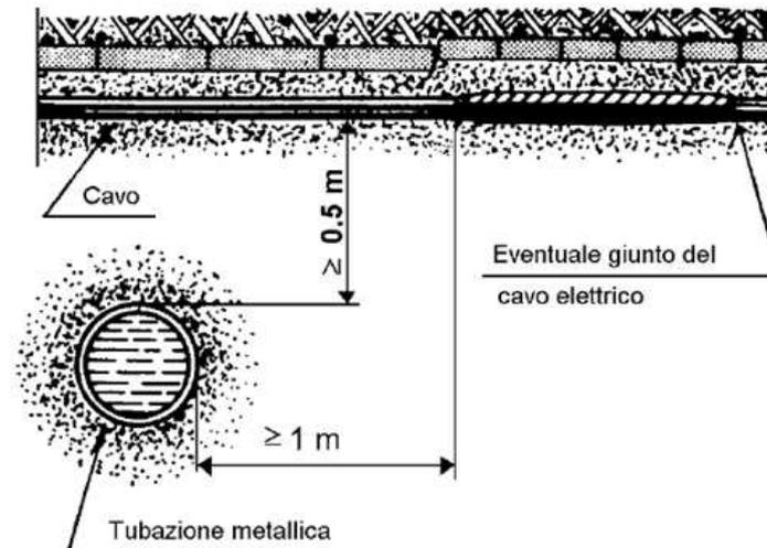
*Figura 7 - Attraversamento tra percorso cavi di energia e tubazioni trasporto fluidi*
