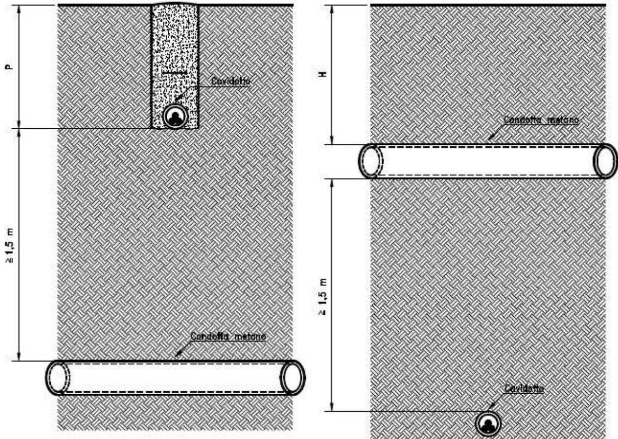
Figura 11 - Attraversamenti di gasdotti - pressione gas  $> 5$  bar
