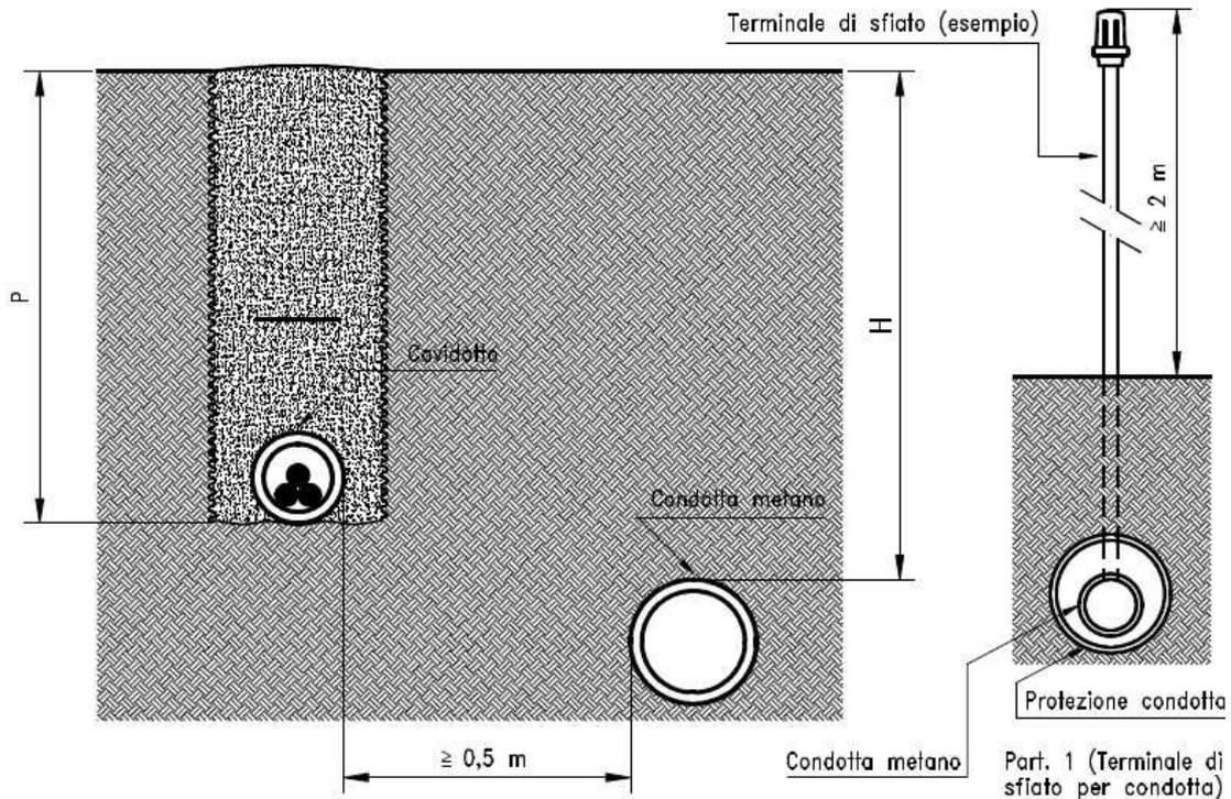
Figura 10 - Parallelismi con gasdotti - pressione gas  $< 5$  bar
