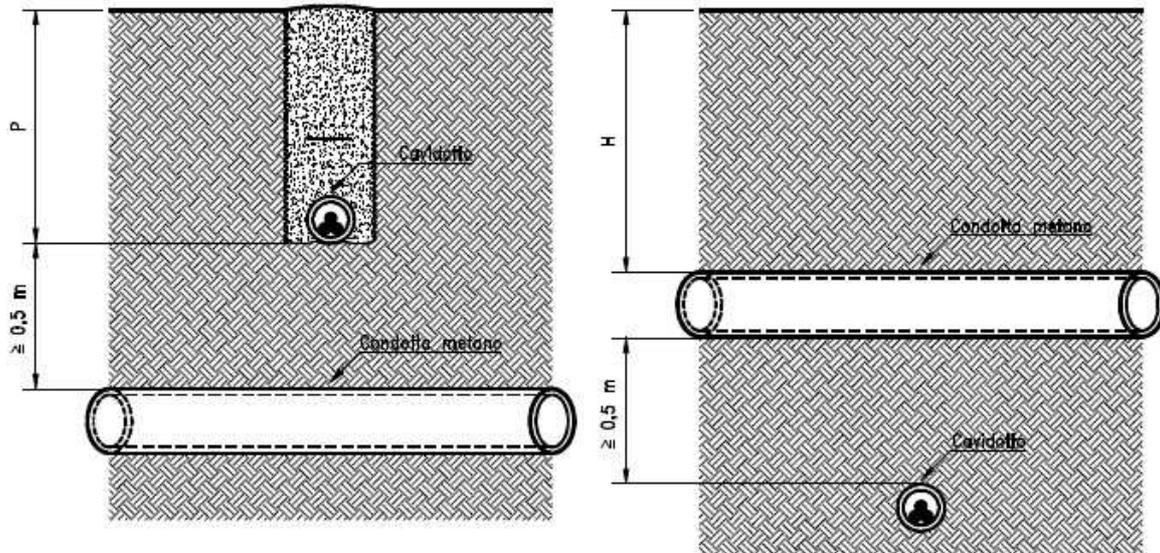
Figura 12 - Attraversamenti di gasdotti - pressione gas  $>5$  bar
