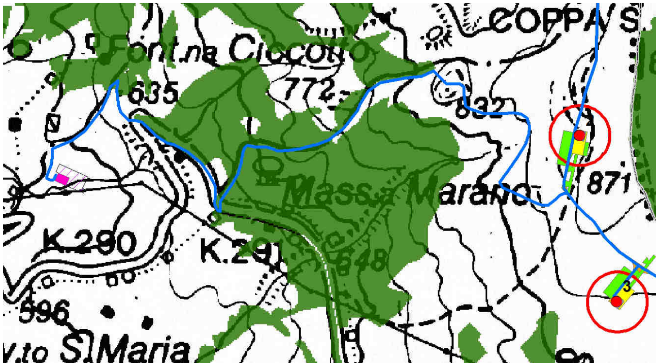
Figura 5. Dettaglio interferenza cavidotto esterno con BP Boschi
