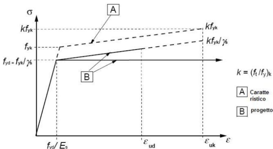
**Figura 6: Legame costitutivo di progetto del acciaio per c.a.**
