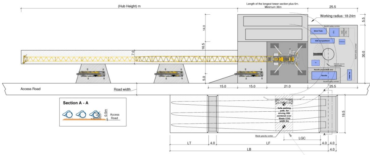
Figura 6 – Caratteristiche piazzola temporanea tipo
