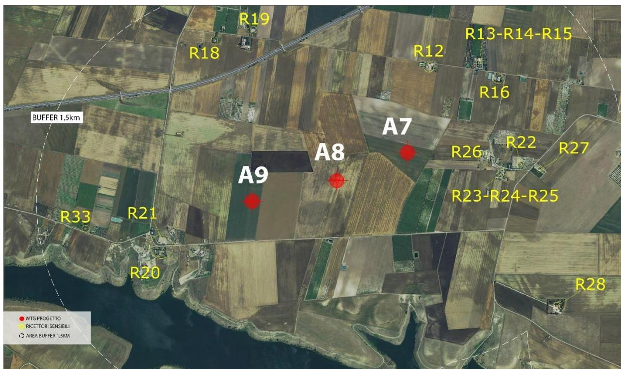
figura 18: Vista della porzione est del parco di Progetto con evidenza delle turbine A7, A8, A9, e dei ricettori sensibili, indicati con etichetta "R", rientranti nel buffer di 1,5 km dalle torri.
