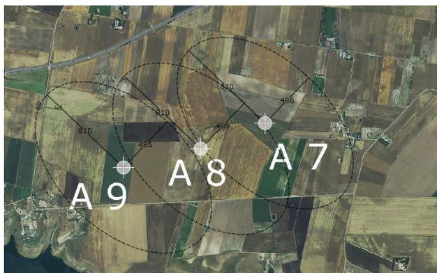
figura 7: schema del layout di progetto con indicazione delle interdistanze tra gli aerogeneratori.
