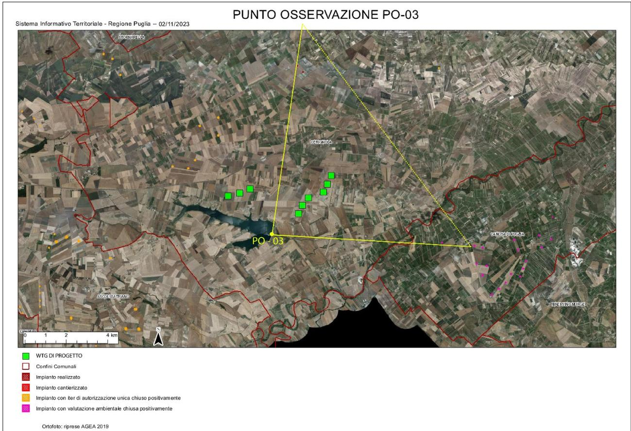
**figura 26: Linee di costruzione per il calcolo dell'indice di visione azimutale del punto di osservazione PO\_03**
