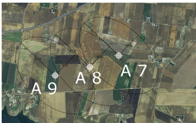
figura 15: schema del layout di progetto con indicazione delle interdistanze tra gli aerogeneratori.
