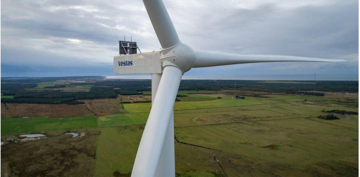
Figura 4.2-2 – Aerogeneratore Vestas Enventus 172 da 6,6 MW di potenza
