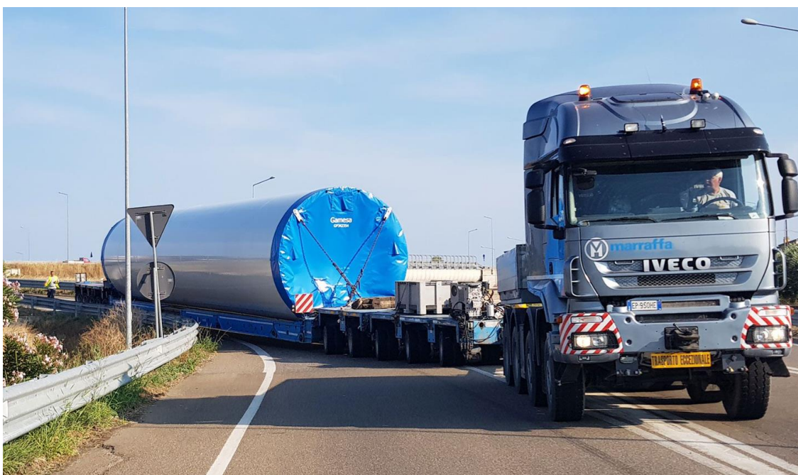
Figura 5 – Trasporto tronco di torre eolica
