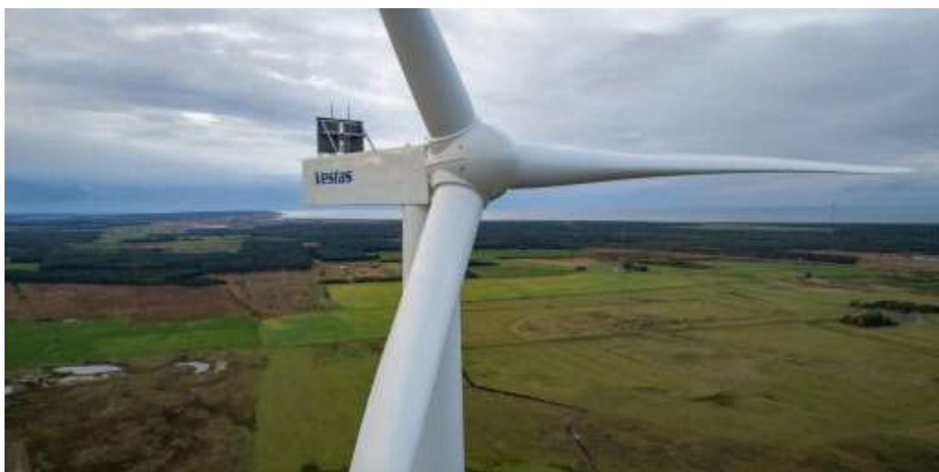
Figure 4-2: Aerogeneratore Vestas Enventus 172 da 6,6 MW di potenza
