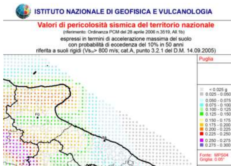
Figura 5-52: Valori di pericolosità sismica del territorio nazionale riferita ai suoli rigidi ( V_s > 88m/s ) consultabile online all'indirizzo http://zonesismiche.mi.ingv.it
