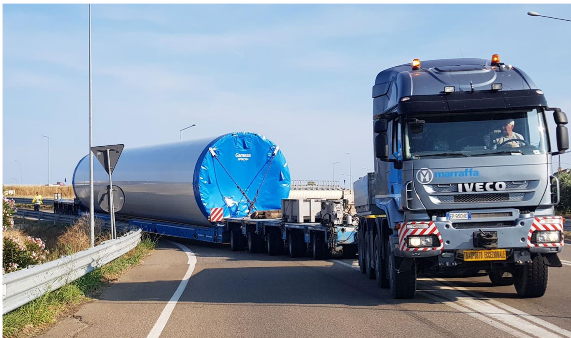
Figura 5-42 – Trasporto tronco di torre eolica
