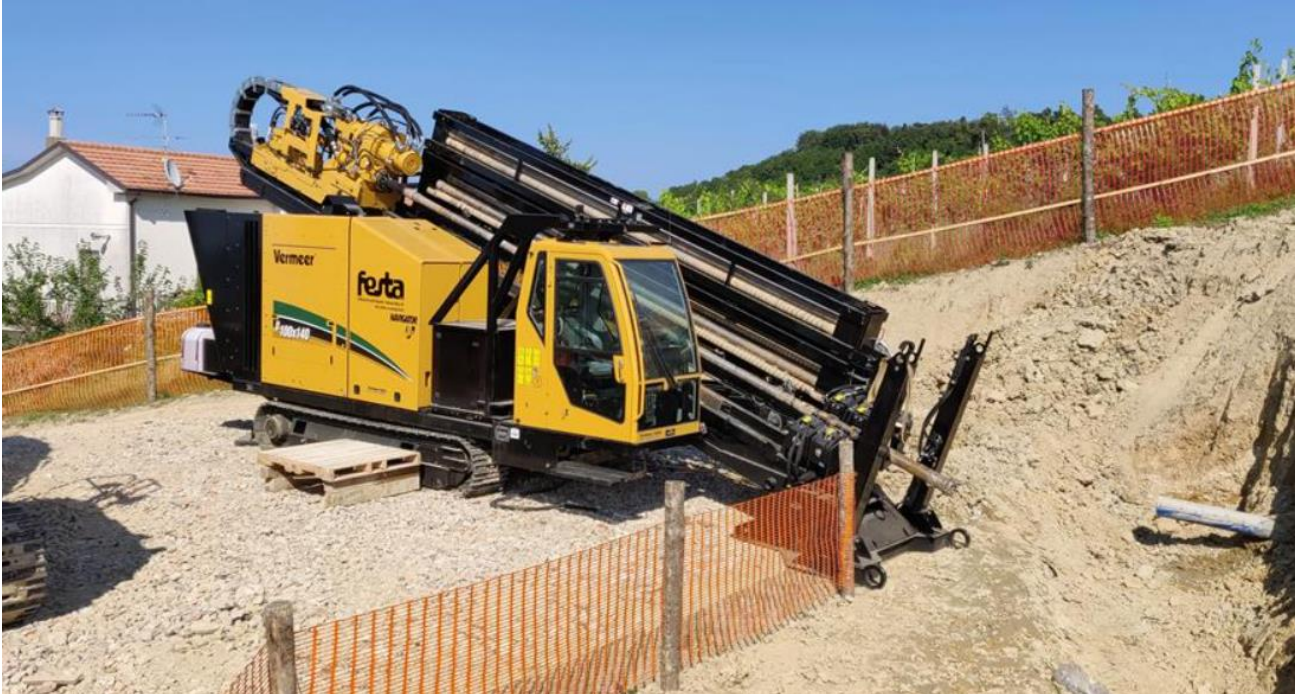
Figura 5-14 – Perforatrice per TOC
