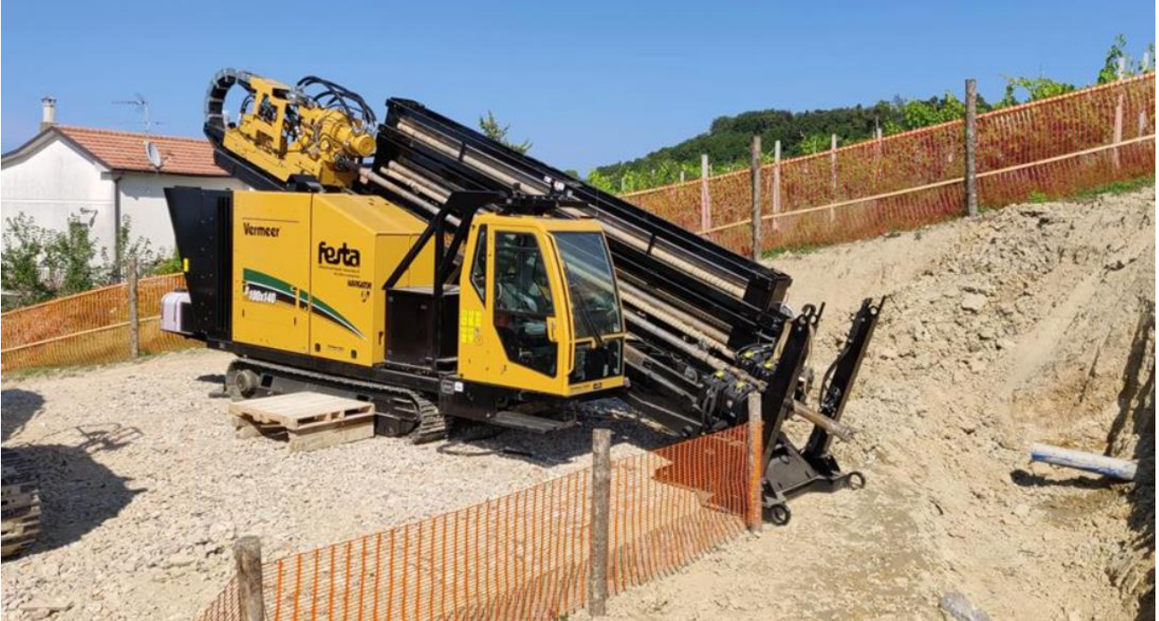
Figura 2—19 – Perforatrice per TOC
