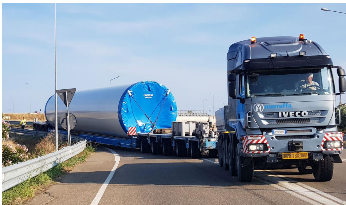
Figura 2—47 – Trasporto tronco di torre eolica
