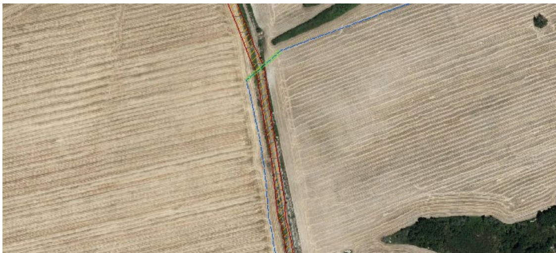
Figura 3.4. – Interferenza con il “Tratturo Comunale di Venosa”: indicazione punto di TOC (in celeste).
