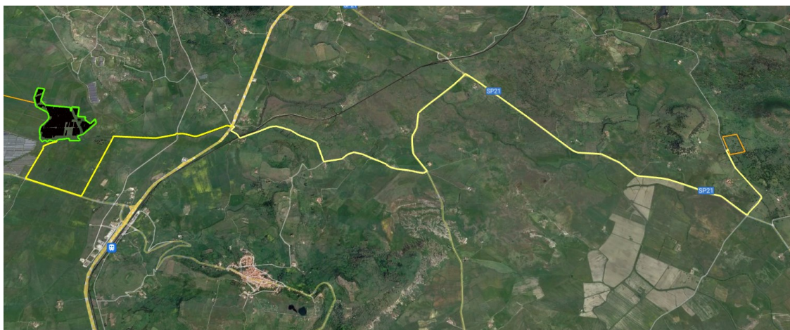
Figura 15- Tracciato cavidotto di connessione alla SE Terna
