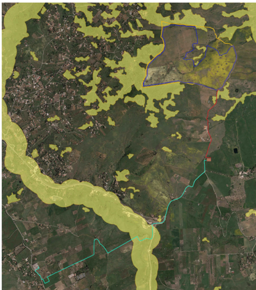
Figura 3 - Stralcio carta Beni Paesaggistici D.Lgs. 42/04 (in blu l’area di impianto, in rosso la linea di connessione a 30 kV e in verde la linea di connessione a 150 kV)
