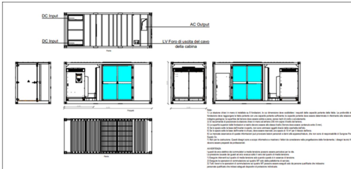
Figura 4.4 Pianta Tipologico Power Station (Progetto Definitivo)
