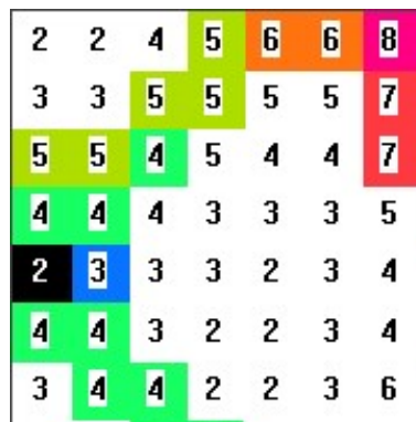
Figura 27– Individuazione dell'uscita per questo sink (pixel in nero) e determinazione del pixel appena prima dell'uscita (pixel in blu).
