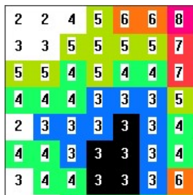
Figura 28– Ai pixel che cooperano al sink (< 3), si assegna il valore prima dell’uscita, cioè 3 (pixel in nero).
