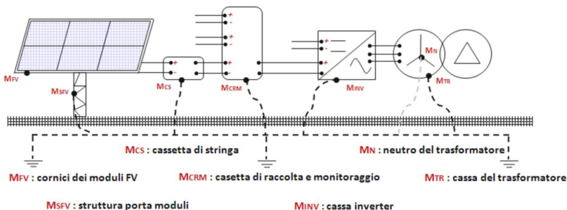
**Figura 7. Schema della messa a terra a monte del trasformatore**
