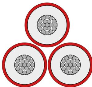
Figura 2. Formazione cavo tripolare ad elice visibile (trifoglio)
