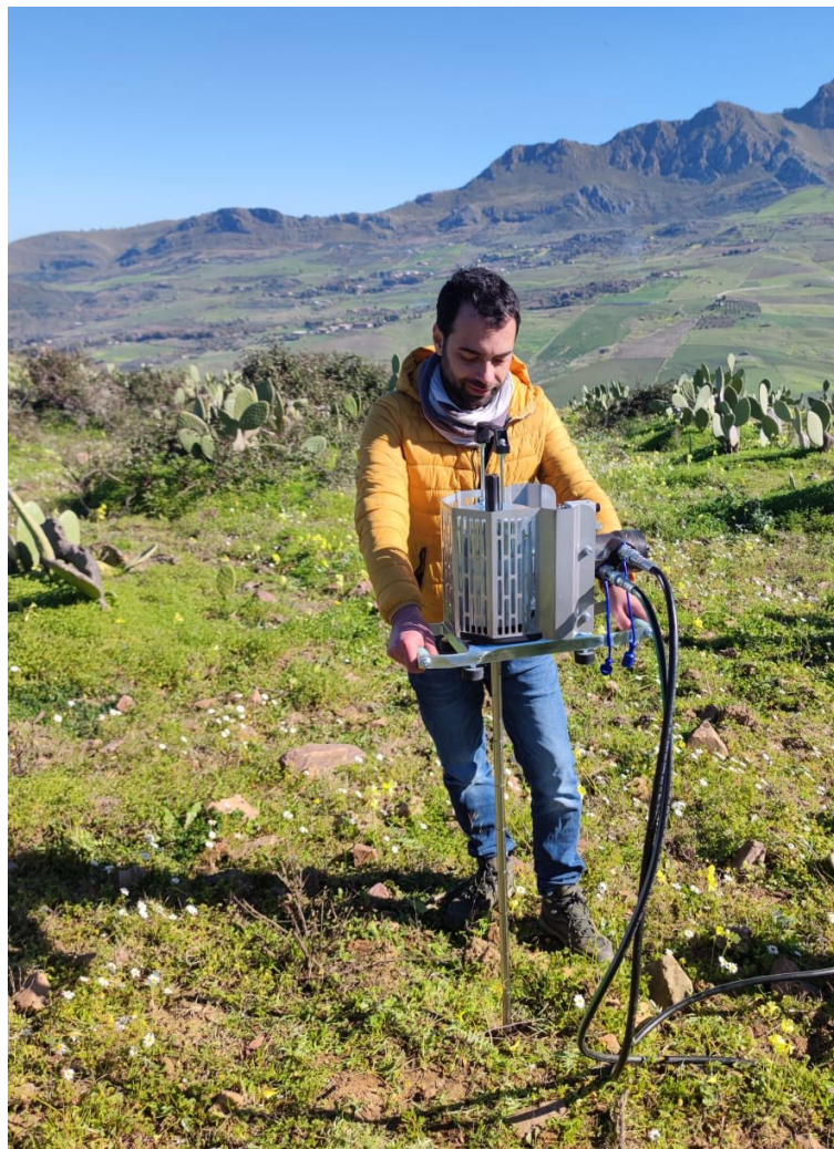
Figura 3 – Fase di acquisizione della prova penetrometrica DP2
