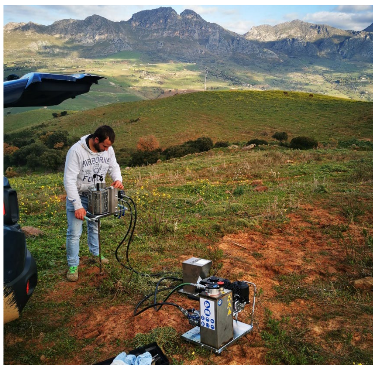
Figura 6 - Fase di approntamento all'esecuzione della prova penetrometrica DP5.
