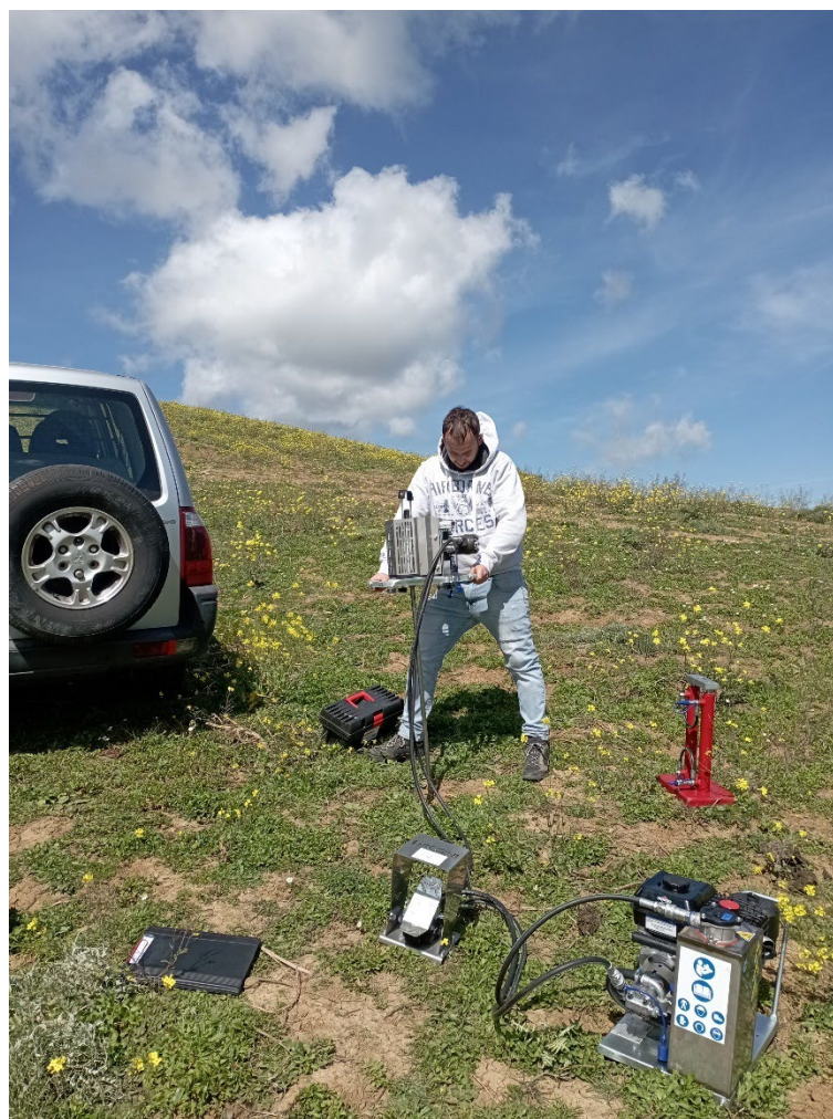
Figura 10 - Fase di approntamento all'esecuzione della prova penetrometrica DP9.
