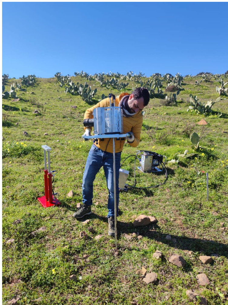
Figura 4 – Fase di preparazione all'acquisizione della prova penetrometrica DP3.
