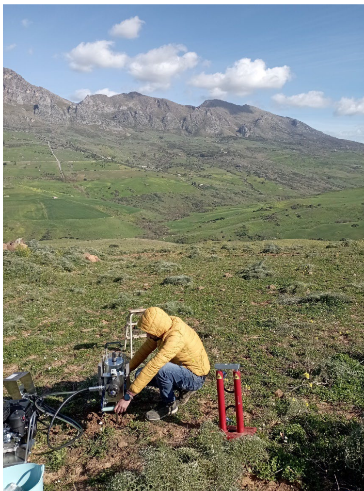
Figura 11 - Fase di esecuzione della prova penetrometrica DP10.
