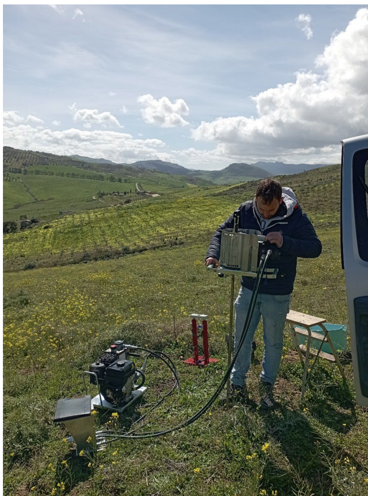
Figura 8- Fase di approntamento all'esecuzione della prova penetrometrica DP7.
