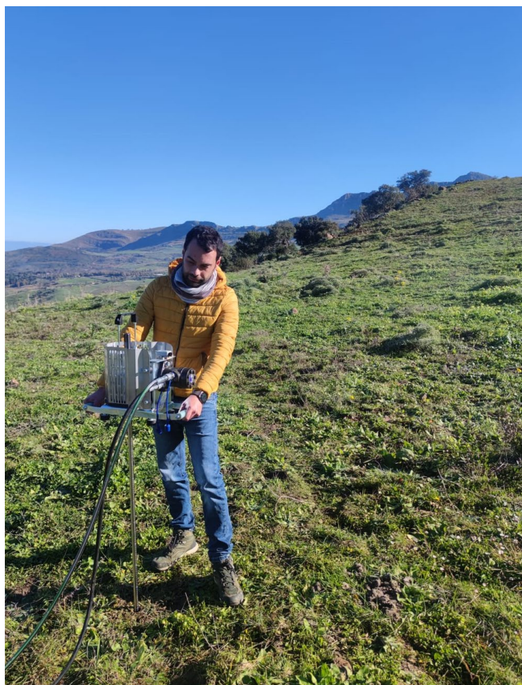
Figura 2 – Fase di esecuzione della prova penetrometrica DP1.
