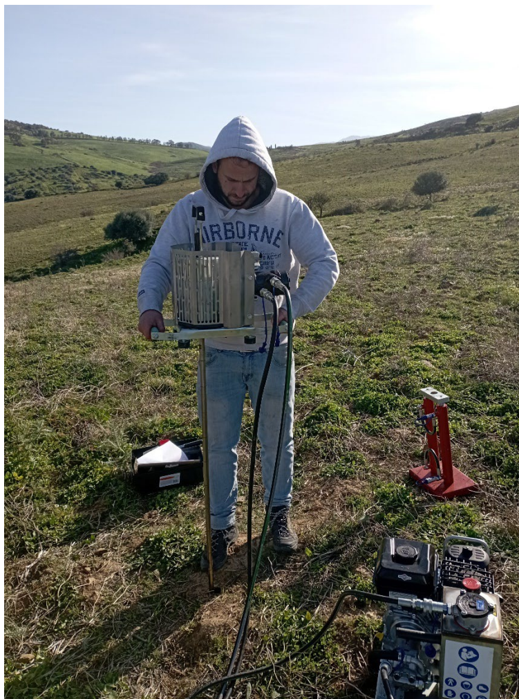
Figura 13 - Fase di esecuzione della prova penetrometrica DP12.
