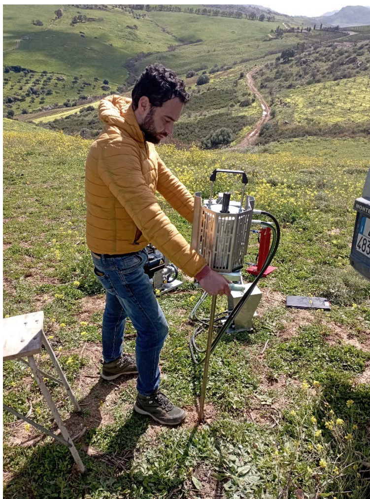
Figura 9 - Fase di approntamento all'esecuzione della prova penetrometrica DP8.
