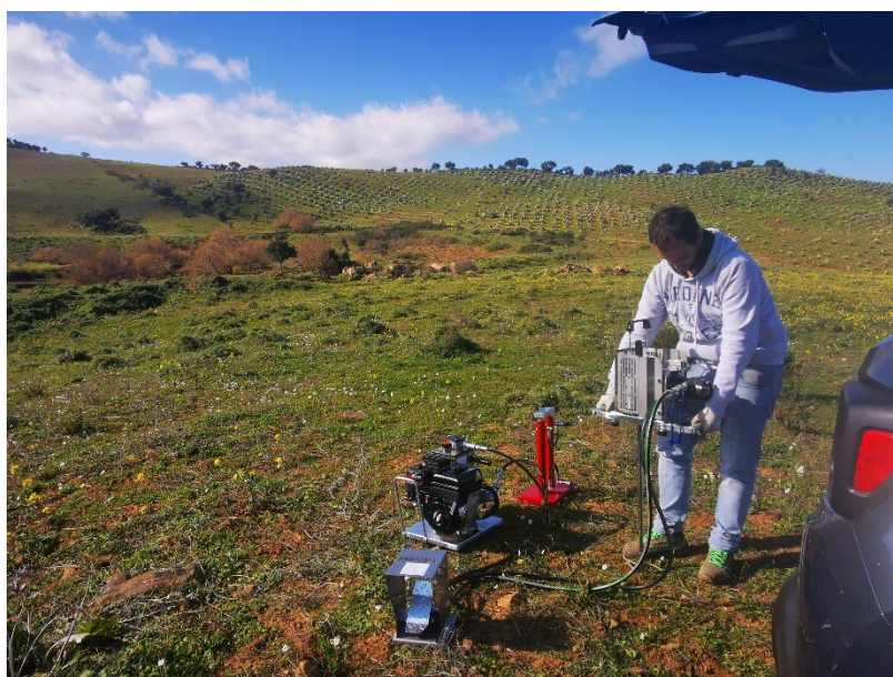
Figura 5 – Fase di approntamento alla prova penetrometrica DP4.
