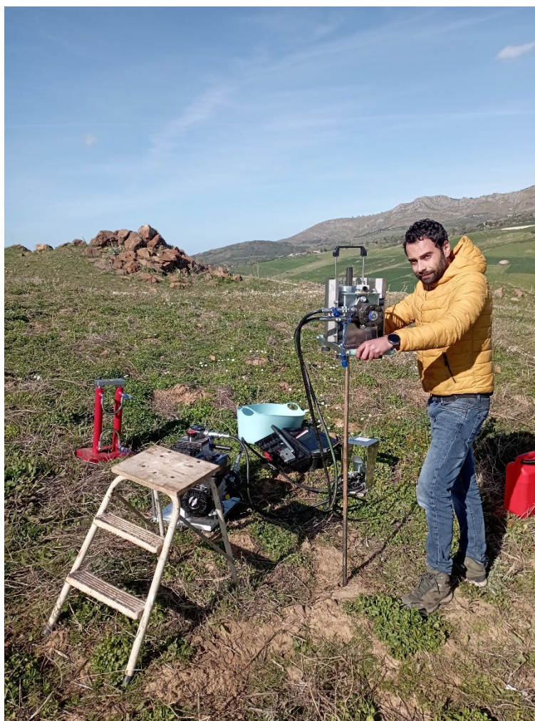
Figura 12 - Fase di esecuzione della prova penetrometrica DP11.
