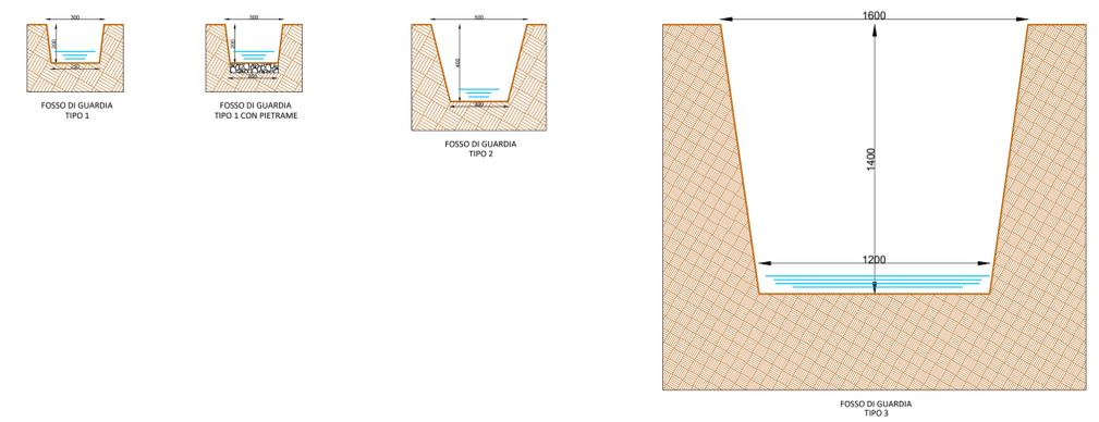
OPERE DI MITIGAZIONE IDRAULICA: Reticolo Idraulico:Trincee Drenanti / Fossi di guardia
