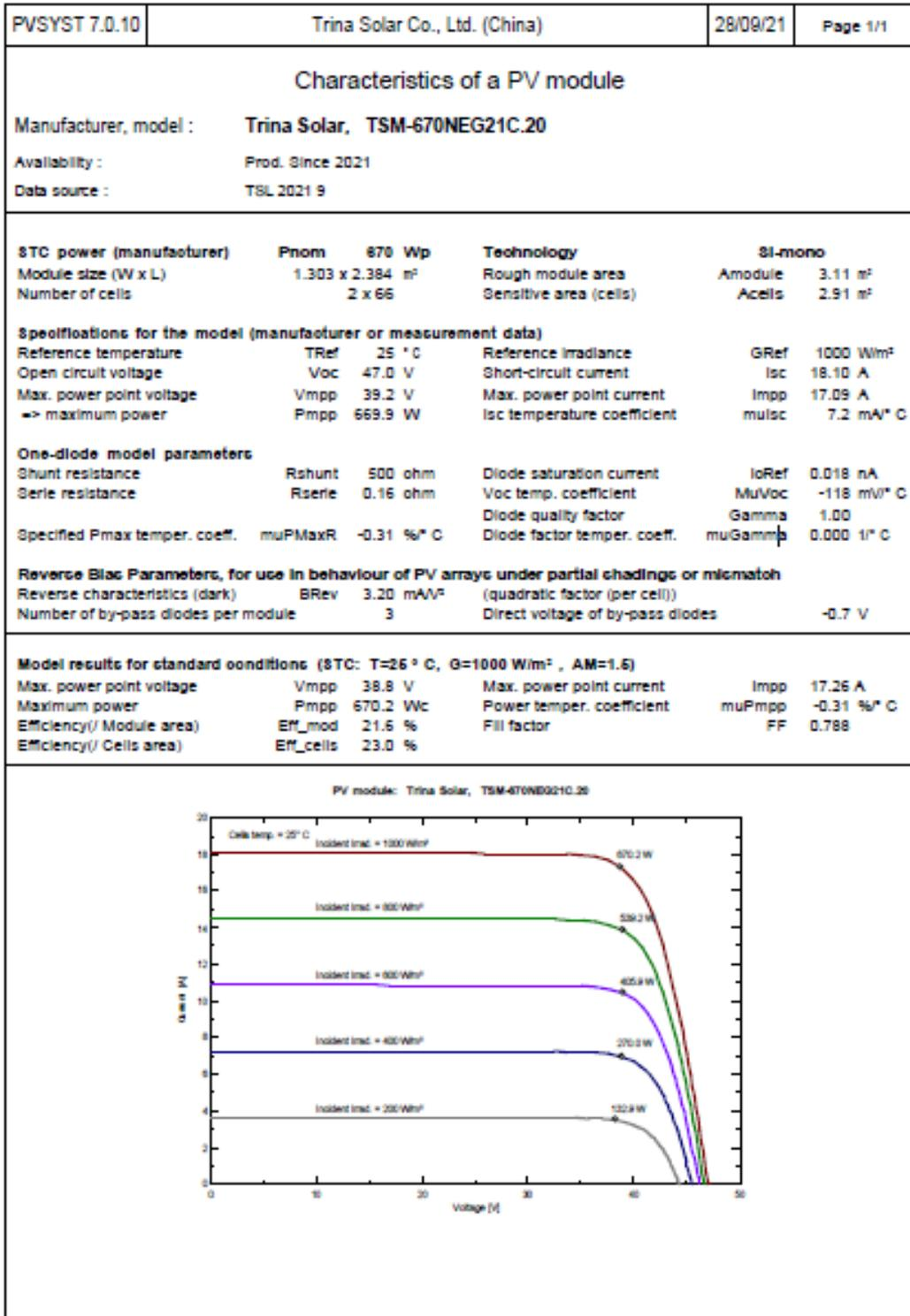
**Fig. 7 - Dimensioni, specifiche tecniche e prestazionali pannelli fotovoltaici Trina Solar**
