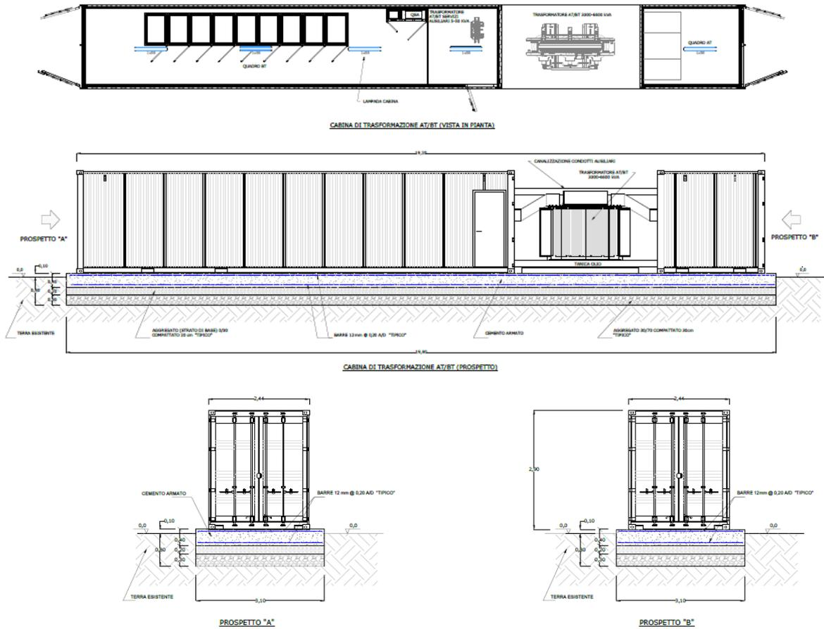
**Fig. 18 - Cabina di trasformazione BT/AT**
