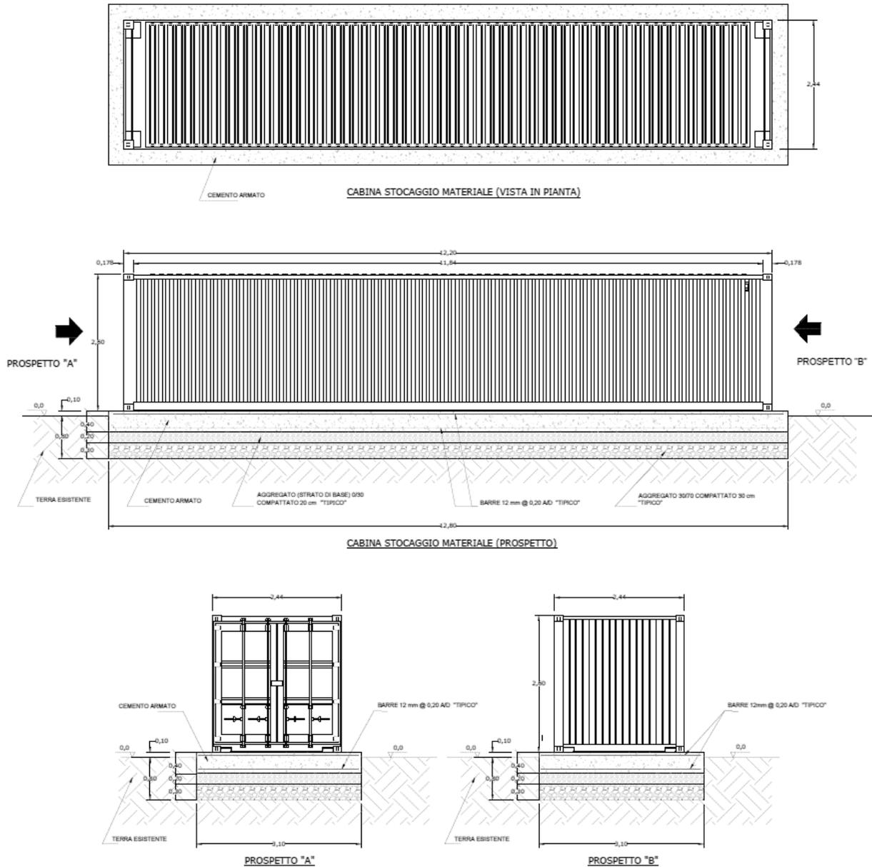
**Fig. 20 - Cabina stoccaggio materiale**
