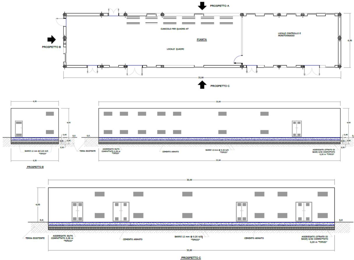
**Fig. 19 - Cabina di ricezione, sezionamento e controllo**
