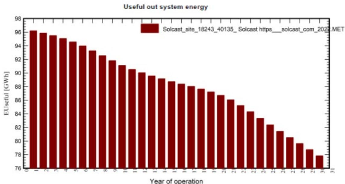
**Fig. 28 – Producibilità dell’impianto con degrado moduli (30 anni)**
