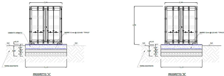
**Fig. 12 - Cabina di trasformazione BT/AT**
