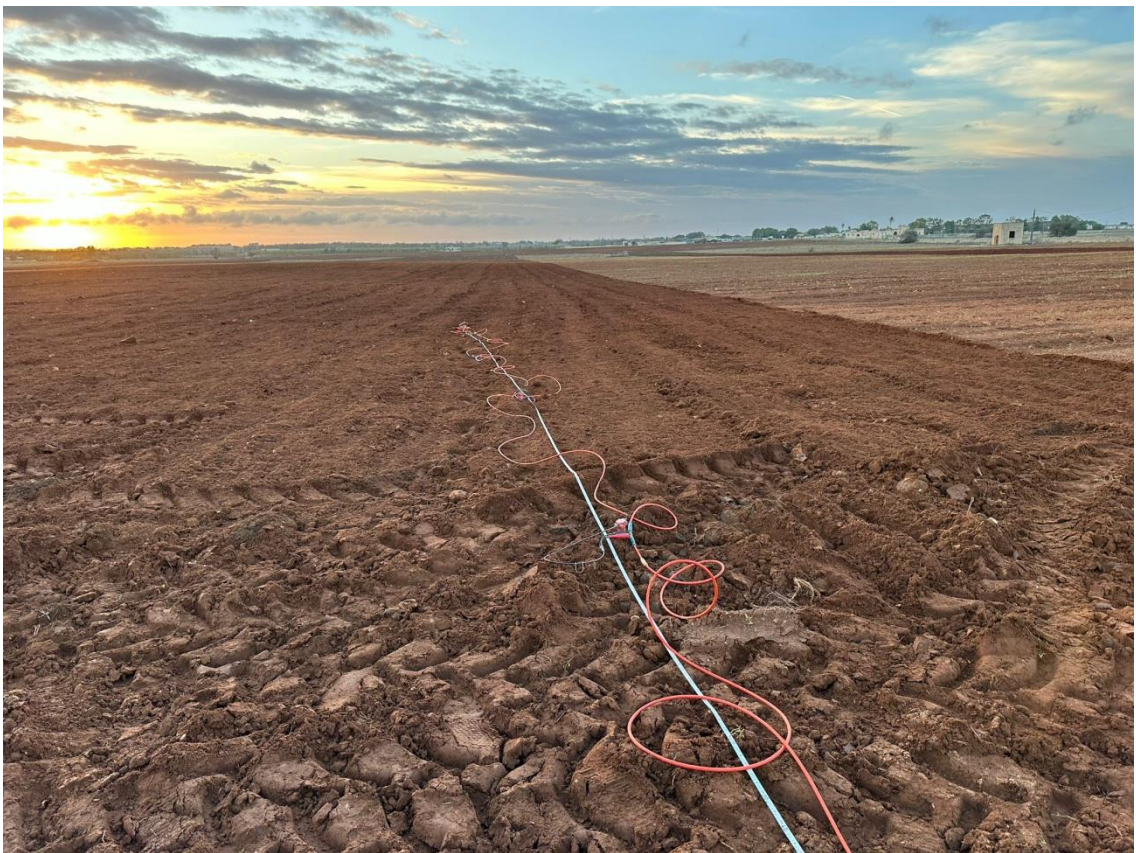
Esecuzione profilo sismico a rifrazione 2
