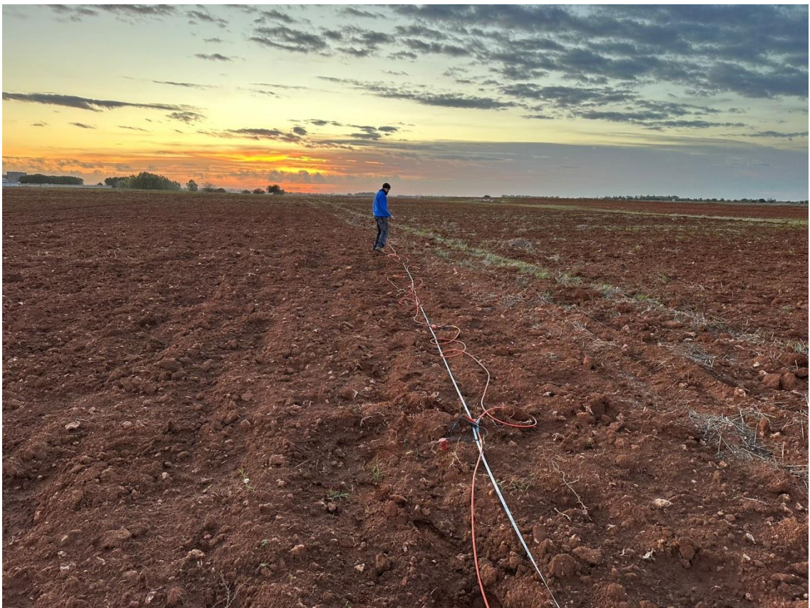
Esecuzione profilo sismico a rifrazione 5- e Masw n.3 sullo stesso stendimento
