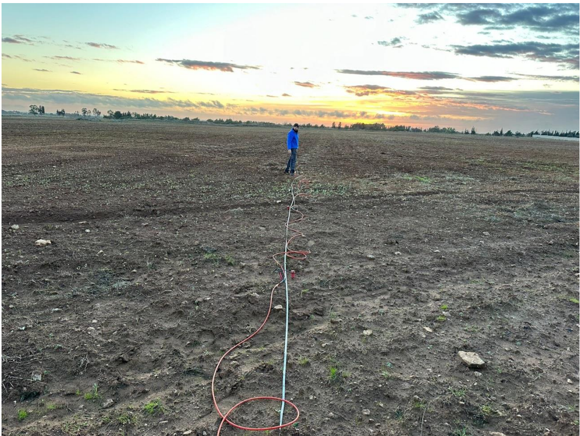
Esecuzione profilo sismico a rifrazione 6- e Masw n.4 sullo stesso stendimento
