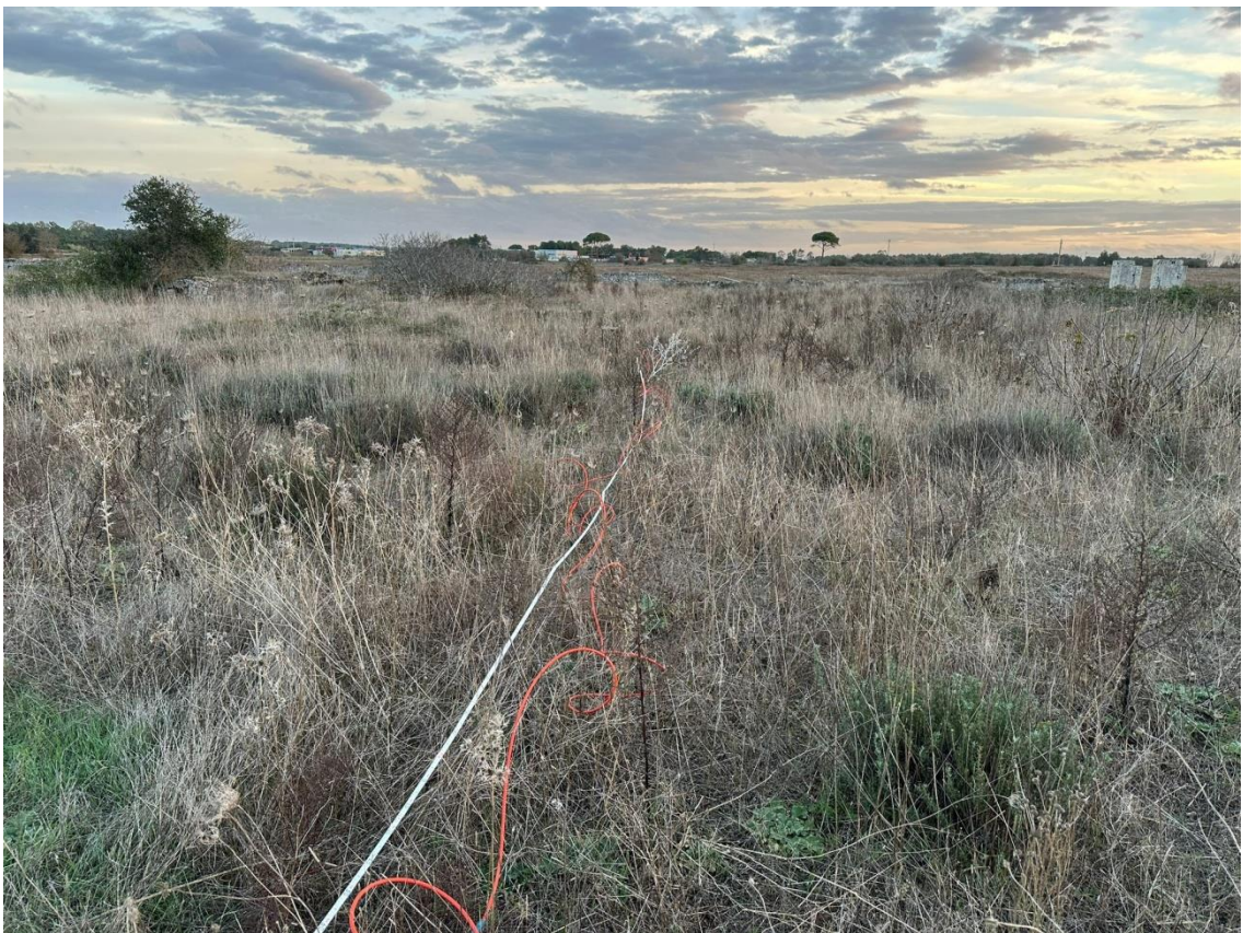
Esecuzione profilo sismico a rifrazione 3- e Masw n.2 sullo stesso stendimento
