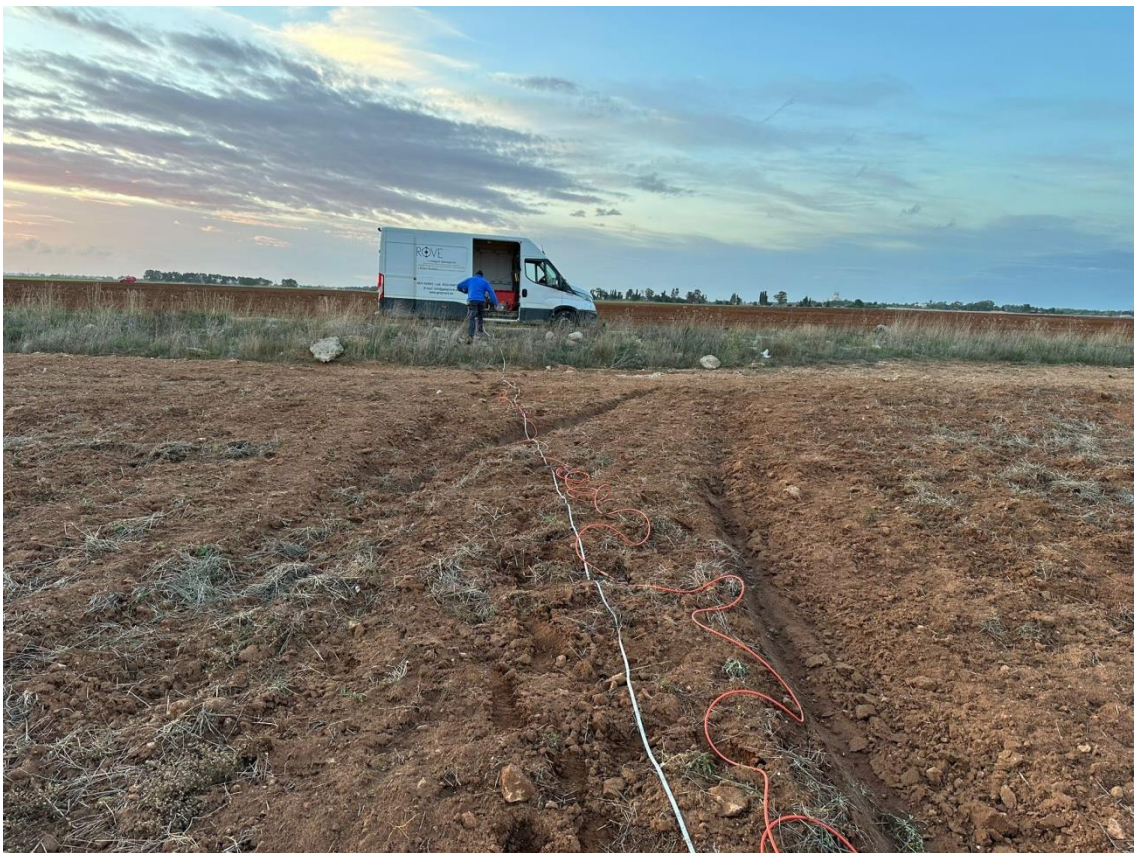
Esecuzione profilo sismico a rifrazione 4
